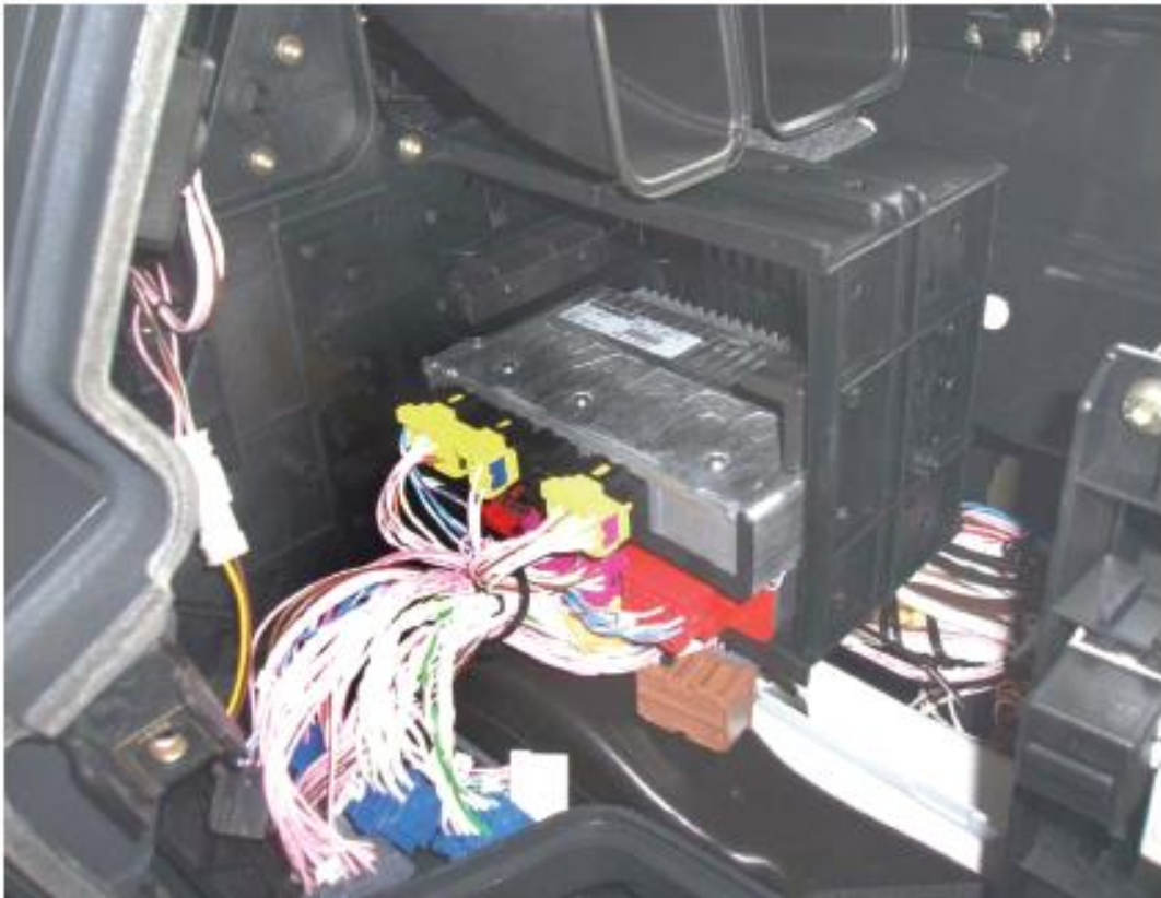
Figura 3-1 Ubicación módulo electrónico de control.
