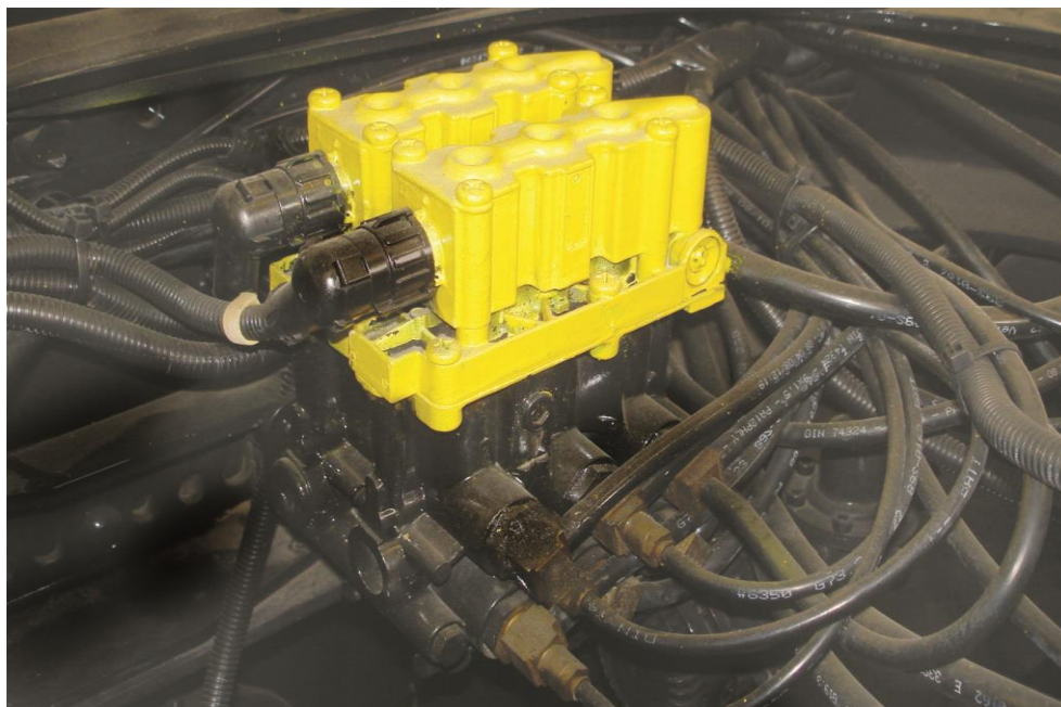
Figura 3-9 Ubicación del bloque de válvulas solenoide.
