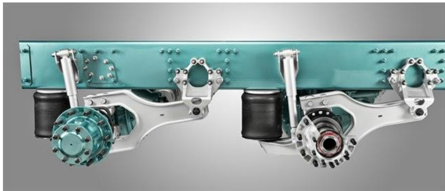
Figura 2-2 Vista lateral de una suspensión neumática común, en camiones.
