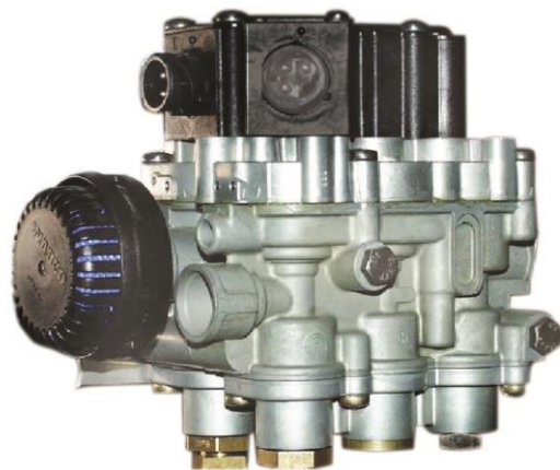
Figura 3-16 Válvula solenoide de las bolsas de aire de la suspensión.
