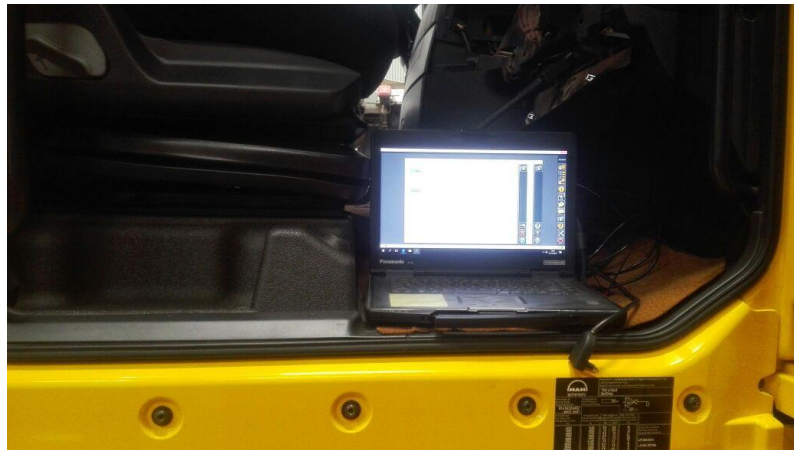
Figura 2-8 Calibración mediante MAN-cats II.
