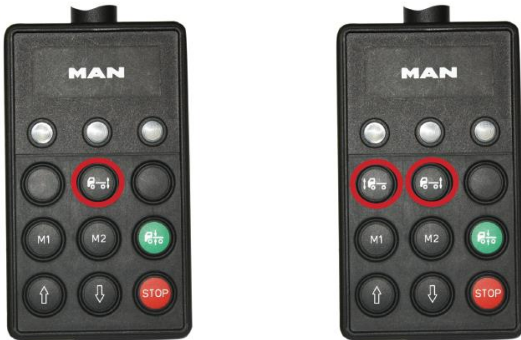
Figura 3-42 Mando a distancia de la suspensión neumática mixta (izquierda), y suspensión neumática completa (derecha).
