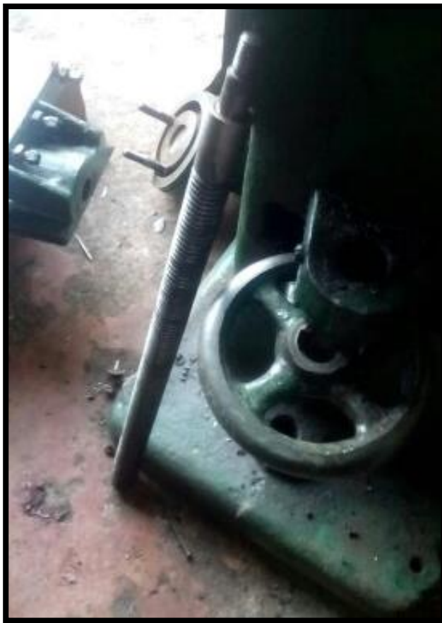
Figura 2-21. Desarme mecanismo de movimiento vertical de la mesa de trabajo
