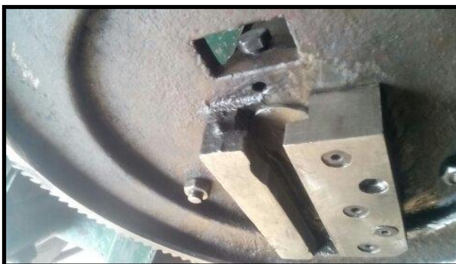
Figura 3-17. Perno de sujeción y evidencia del desplazamiento del eje
