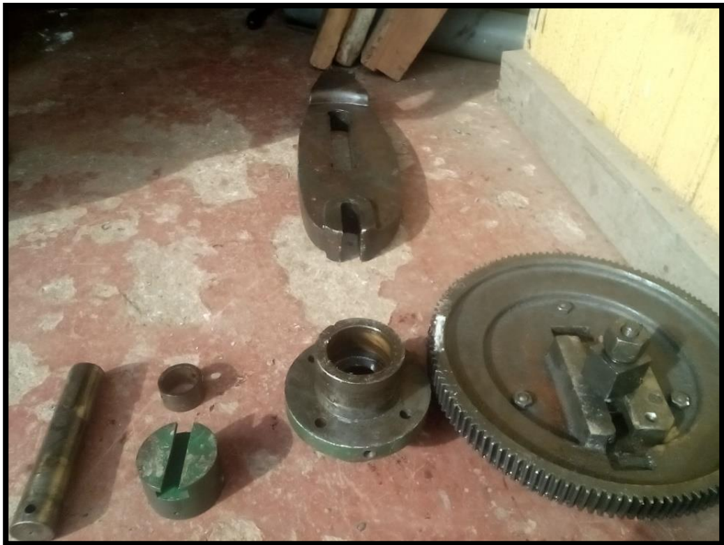
Figura 2-12. Elementos interiores mecanismo de planto excéntrico y biela oscilante
