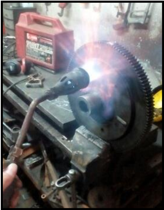
Figura 3-10. Precalentamiento de rueda dentada
