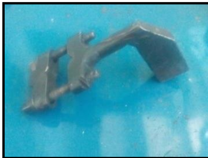
Figura 3-13. Perro de arrastre encontrado en el taller de mecánica industrial de la Universidad Técnico Federico Santa María, sede José Miguel Carrera
