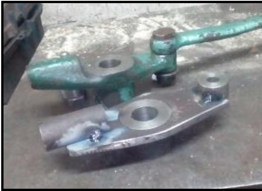
Figura 3-32. Unión de componentes mediante soldadura
