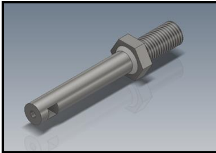
Figura 3-41. Modelo porta herramienta para trabajos en diámetros mayores
