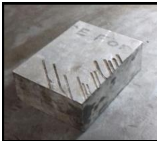
Figura 3-50. Trozo de aluminio mecanizado en prueba de funcionamiento
