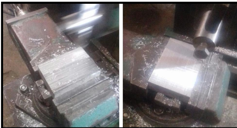
Figura 3-51. Ilustraciones proceso de desbaste y afinado
