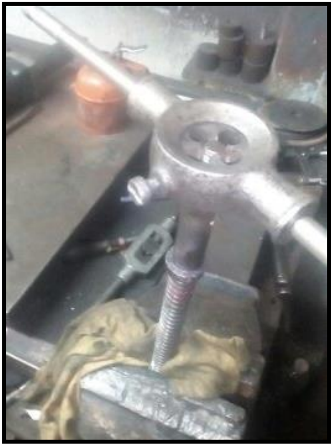
Figura 3-22. Proceso de roscado con terraja
