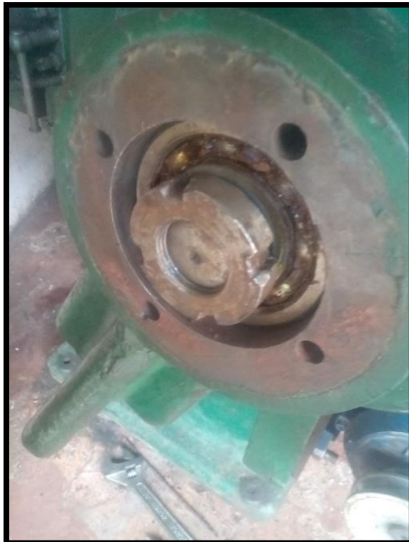
Figura 2-3. Estado inicial rodamiento del sistema de velocidades
