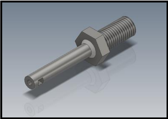
Figura 3-40. Modelo porta herramienta para trabajos en diámetro pequeños
