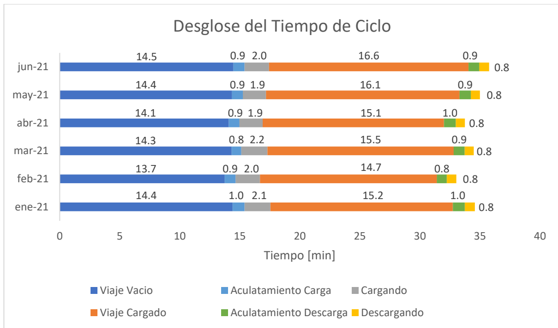
Figura 28: Desglose del tiempo de ciclo efectivo de la flota Komatsu 930E-4SE para los periodos de análisis.
