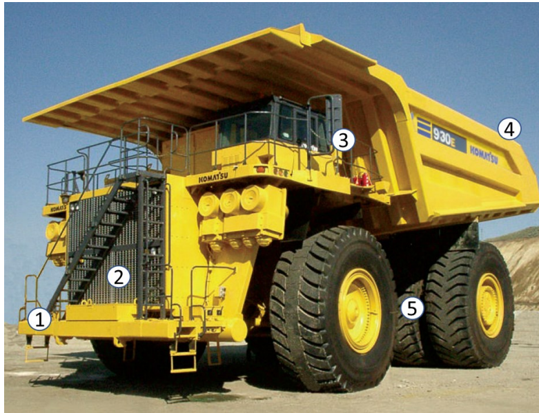
Figura 5: Componentes de camión minero: 1. Escalera, 2. Motor, 3. Cabina, 4. Tolva, 5. Ruedas.
