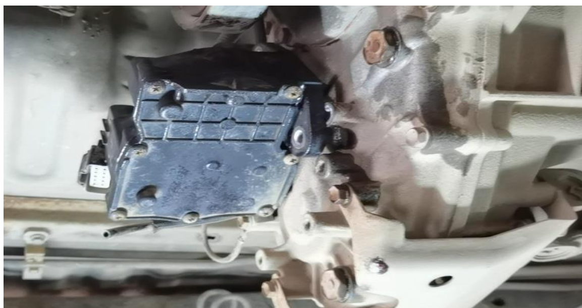
Imagen 3-29: colocación de pernos de tapa de actuador
