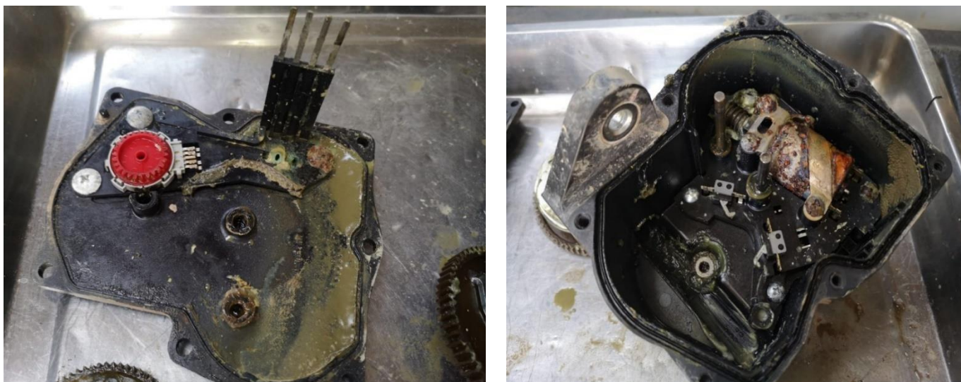
Imagen 3-17: componentes dañados del actuador de transfer
