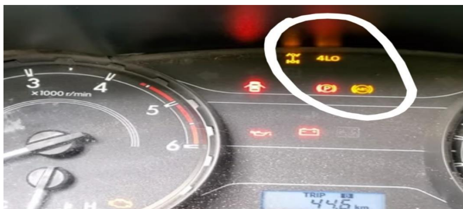
Imagen3-15: luces de falla en tablero
