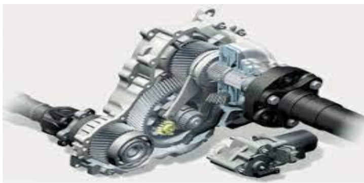
Imagen 1-15: caja de transferencia
