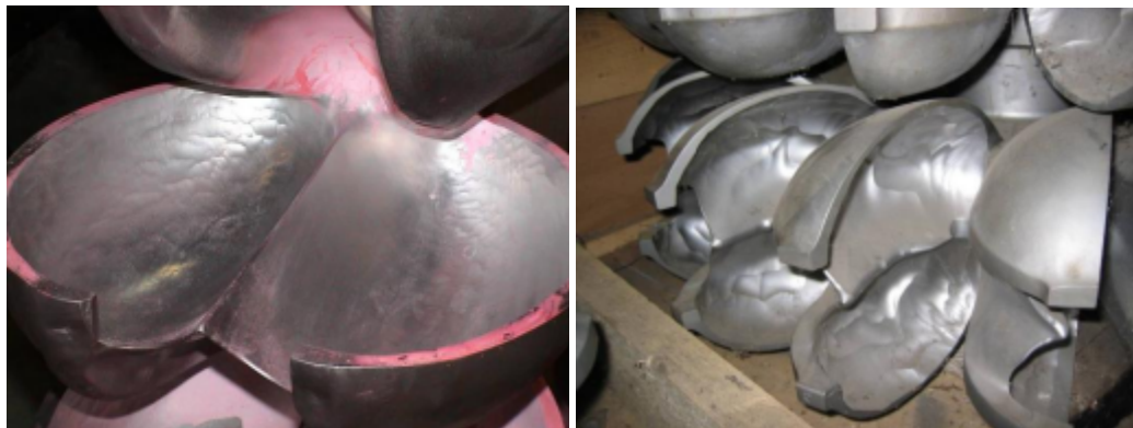
(a) Pala de turbina Pelton con la superficie erosionada en Khimti, Nepal.
