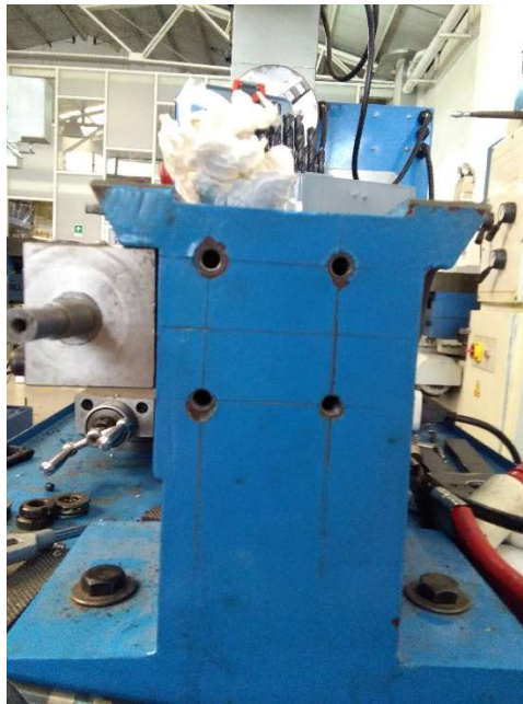
Figura 60. Perforaciones realizadas a la bancada.
