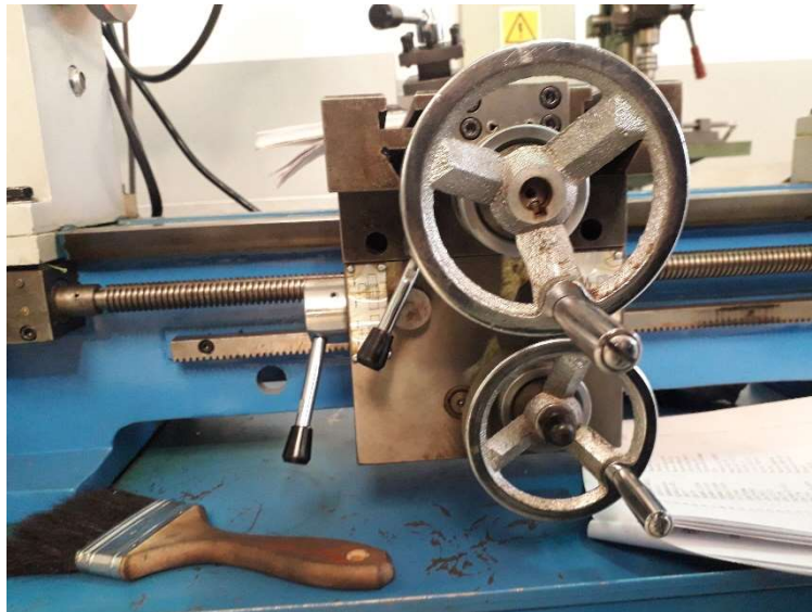
Figura 14. Volantes de operación manual de ambos ejes, arriba el del carro transversal y abajo el del carro principal.
