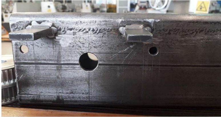
Figura 51. Soporte de motor eje X construido.
