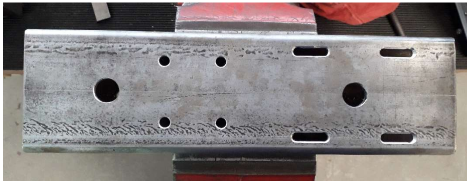
Figura 52. Soporte del motor del eje Z construido.
