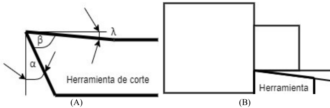
Figura 3. Ángulos principales de una herramienta de corte.
