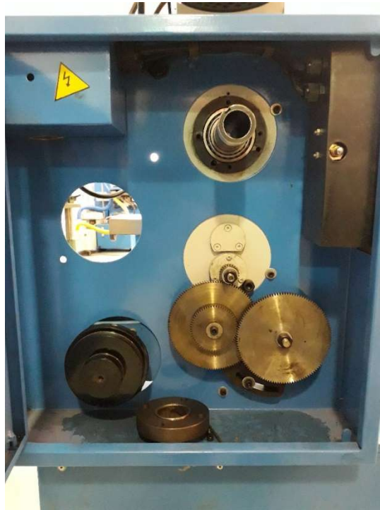
Figura 33. Caja del sistema de transmisión del movimiento al cabezal fijo del torno.
