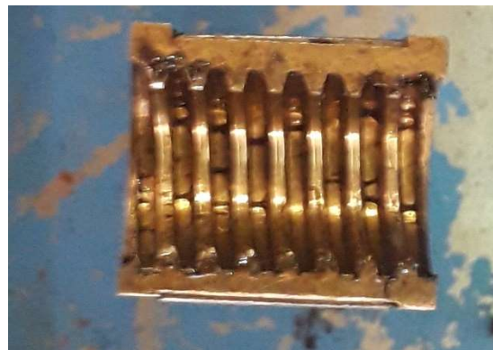
Figura 39. Tuerca partida del eje z para el movimiento automático del carro principal.
