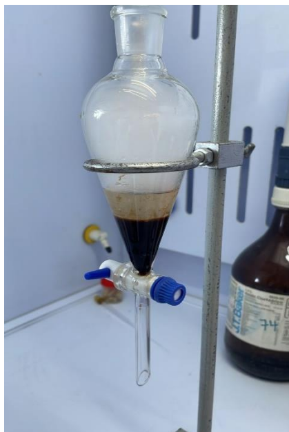
Figura 10: Primera separación de fases luego de aplicado el HCl
