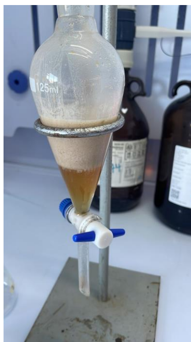
Figura 11: Segunda separación por decantación luego de agregado el solvente DCM
