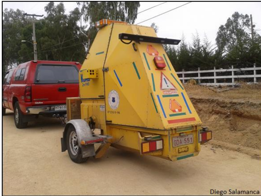
Figura 3-11: Deflectómetro de impacto KUAB, perteneciente al LNV
