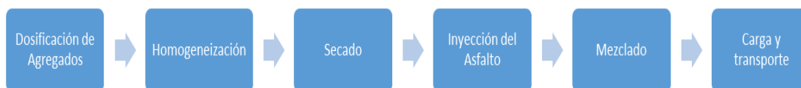
Figura 4-2: Diagrama de proceso de una planta continua
