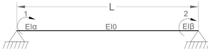
Figura 5.49. Modelo de plasticidad concentrada de Giberson.
