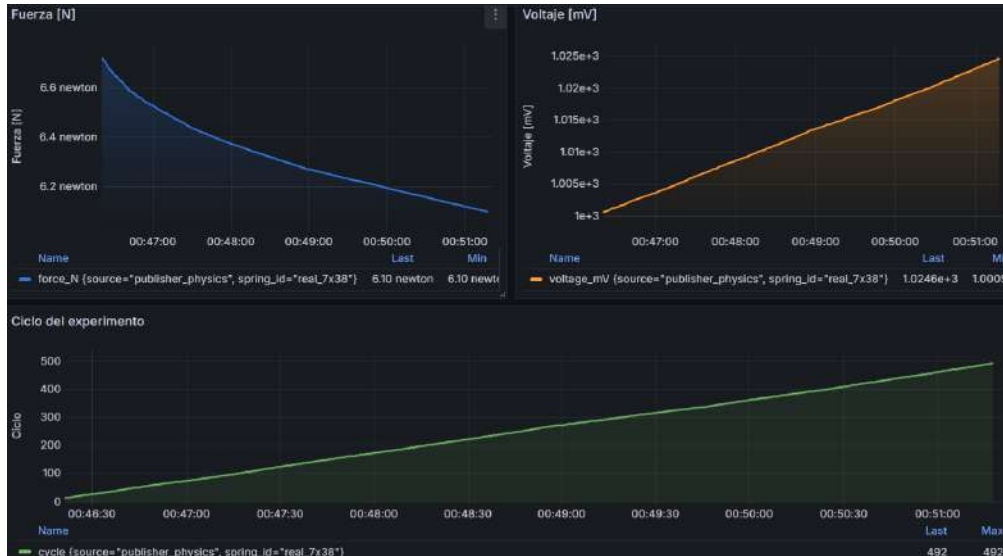
Figura 3.4: Panel de Grafana con las tres señales del experimento (fuerza, voltaje y ciclo). La curva de fuerza muestra la degradación progresiva por fatiga a lo largo de 1000 ciclos.
