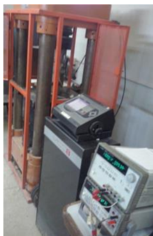
Foto N° 11: Prensa hidráulica, MCC8 para ensayo de Modulo de Elasticidad.
