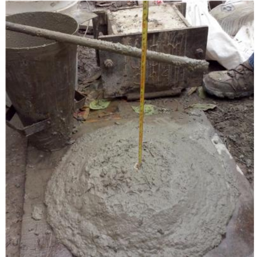
Foto N° 2: Método de asentamiento Cono de Abrams.
