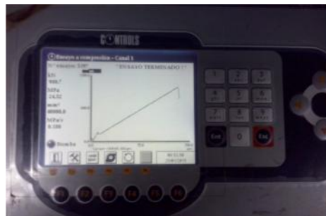
Foto N° 8: "Pantalla de comandos Controls MCC8".
