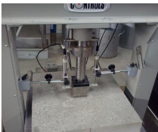
Foto N° 1: Ensayo Panel Cuadrado EFNARC.
