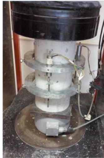
Foto N° 9: Probeta y Sistema de anillos.
