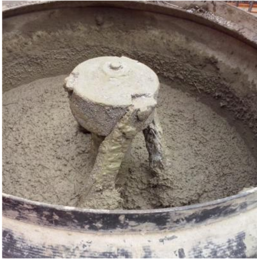
Foto N° 3: Mezcla homogénea lista para verter.
