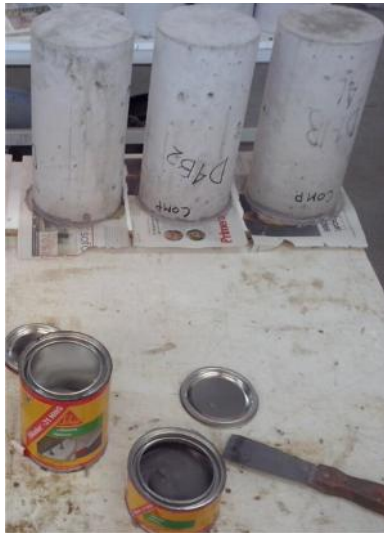
Foto N° 5: Probetas cilíndricas refrentadas con Sikadur 31 HMG.
