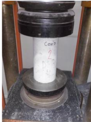
Foto N° 7: Ubicación probeta en platos de la prensa.
