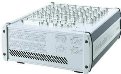
Figura 5.13: MicroLabBox dSpace modelo ds1202.
