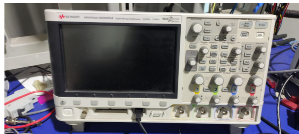
Figura 5.16: Osciloscopio Keysight modelo DSOX2014A.
