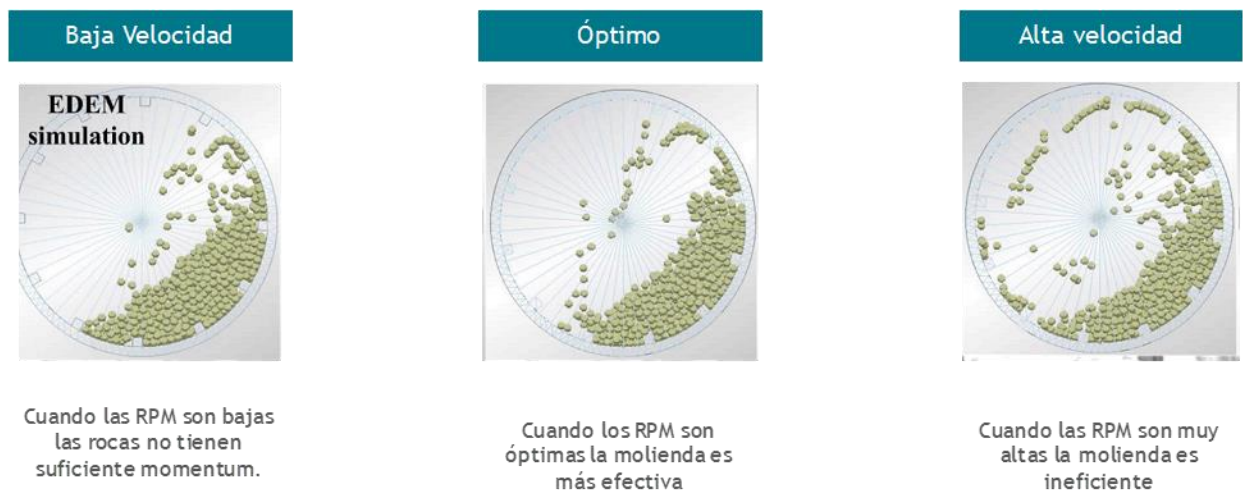
Figura 4: Perfil de velocidad de rotación del molino
