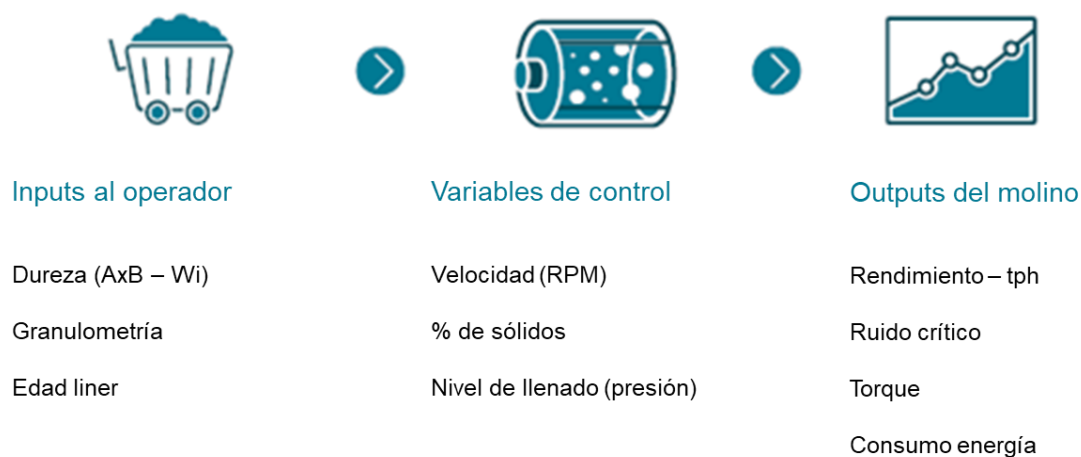
Figura 6: Modelo de red neuronal para estimación del procesamiento de mineral del Molino SAG variables
