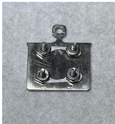
Figura 3.3: Portamuestras utilizado para la evaporación de películas de cromo y su posterior caracterización mediante STM, diseñado para asegurar un buen contacto eléctrico y permitir la realización de las mediciones sin romper las condiciones de vacío.
