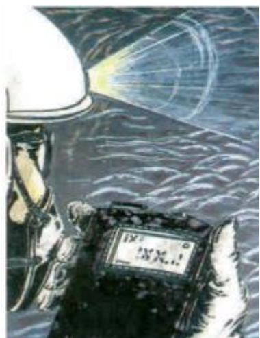
Figura 25: Verificación de las Condiciones de Ventilación y Visibilidad.
