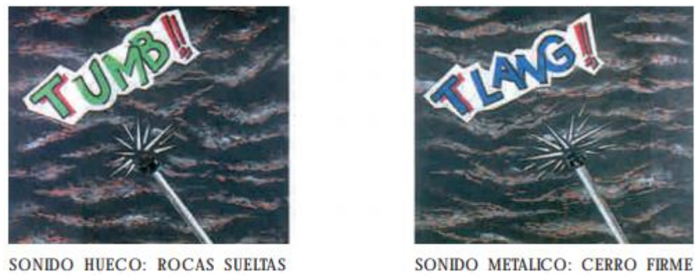
Figura 29: Detección de Planchones.
