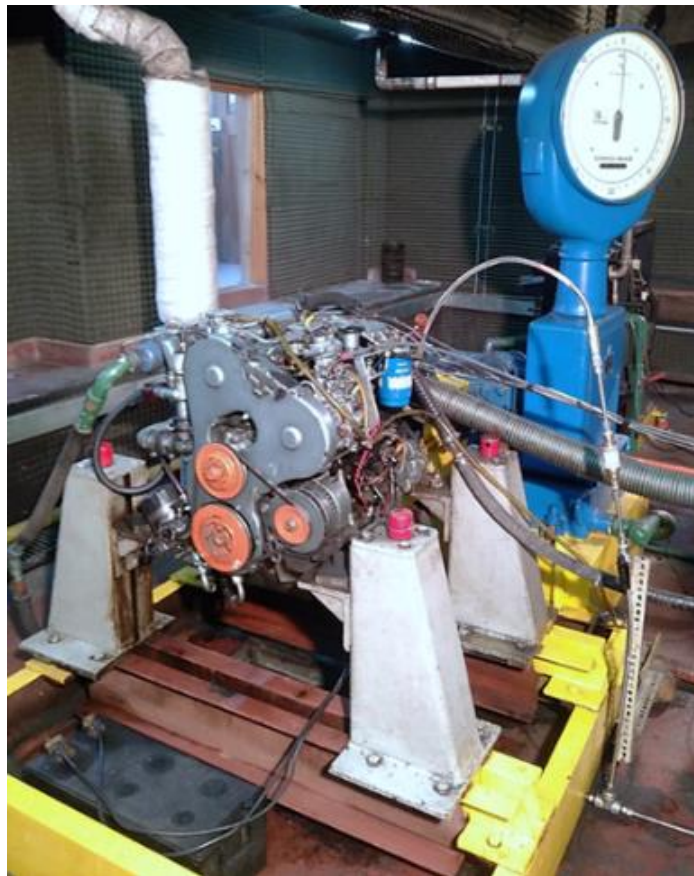
Figura 3.2: Interior de cabina de pruebas, conjunto motor-freno.
