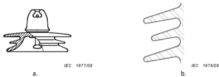
Figura (A 4): Perfiles alternativos típicos. a. Aislador de disco con aletas, b. Perfil de aleta alternativa para aisladores de barra larga- tipo post- tipo hueco. [3]
