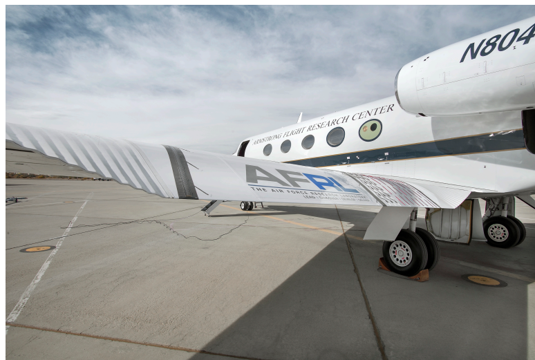
Figura 4.2: Avión Gulfstream III provisto de flaps modificados. Nótese la transición suave entre las superficies flexibles y rígidas. [6]
