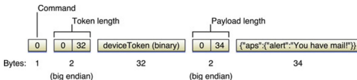
Figura 3.6 – Estructura de una notificación push .
