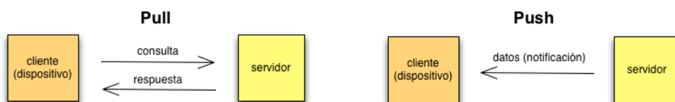
Figura 2.1 – Comparación entre tecnologías pull y push. Fuente: Elaboración propia
