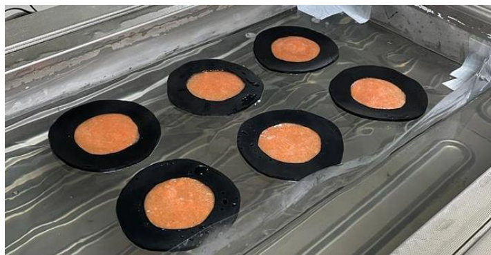
Figura 5. Secado de pulpa de tomate en ventana refractiva.
