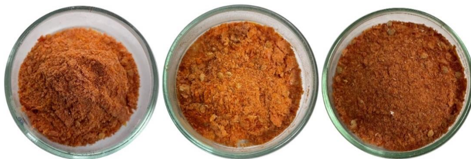
Figura 19. Polvo de tomate obtenido en ventana refractiva a 70, 80 y 90°C, respectivamente.
