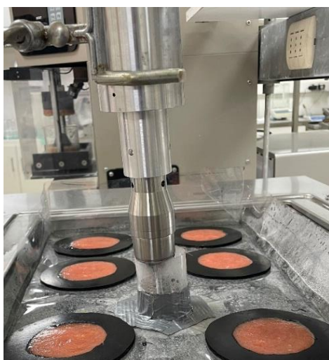
Figura 7. Secado de pulpa de tomate en ventana refractiva con ultrasonido.
