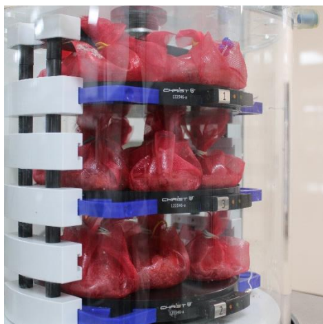
Figura 8. Secado de pulpa de tomate en liofilizador.
