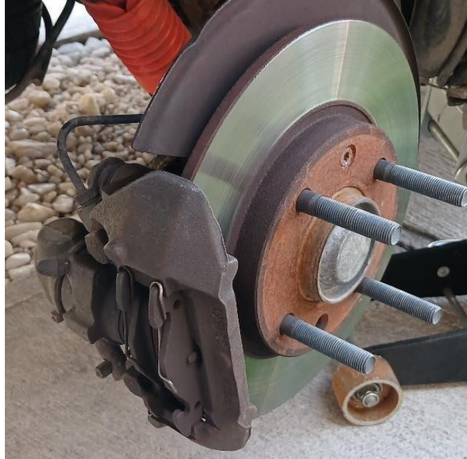
Figura 2-17: Conjunto de frenos trasero del vehiculo citroen AX GTi en estudio, vista frontal.
