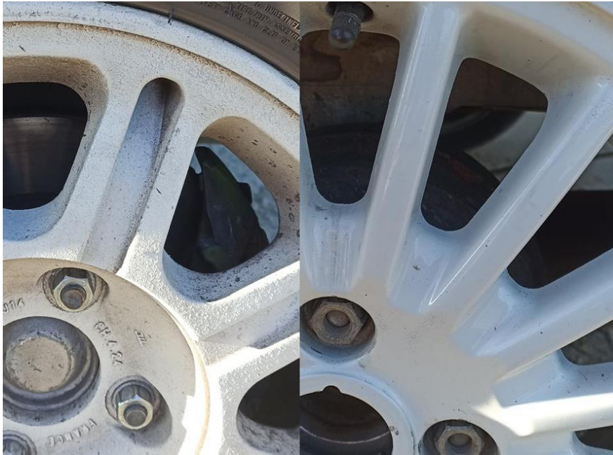
Figura 4-31: Diferencia visual, AX GTi con frenos de disco atrás tipo S16 vs frenos de tambor originales GTi en la parte posterior del modelo GT.
