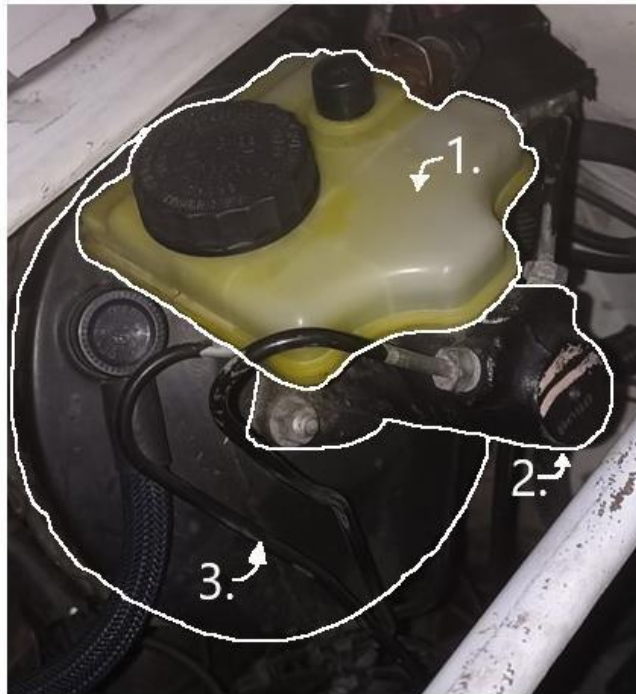
Figura 2-9: Conjunto de servo freno, bomba de freno y recipiente de líquido de frenos del vehículo Citroën AX GTi en estudio.
