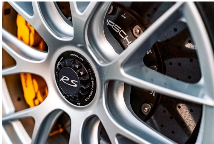
Figura 2-21: Discos de freno delanteros carbocerámicos equipados en un Porsche 911 GT3 RS.
