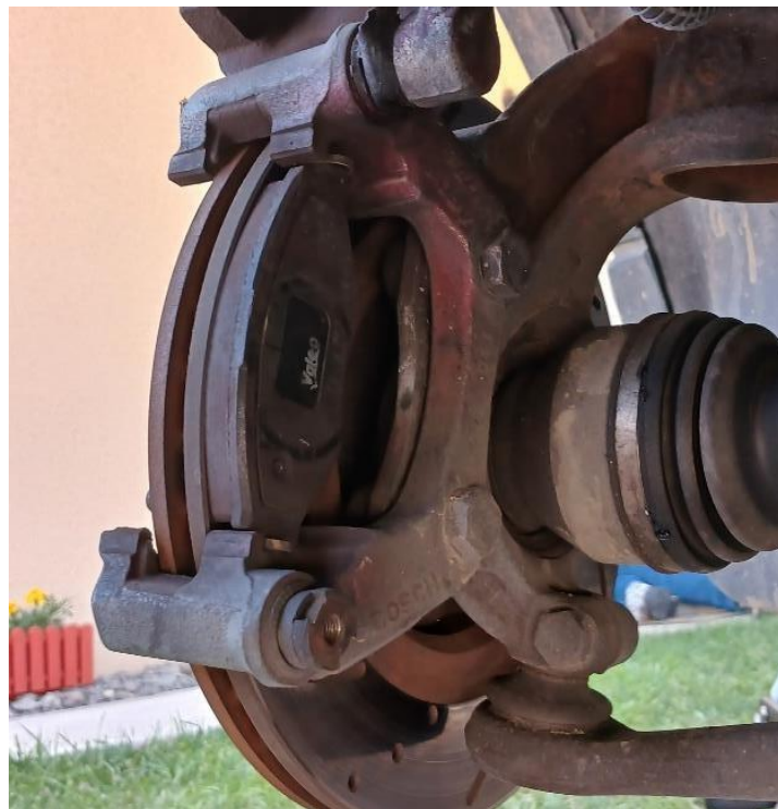
Figura 2-14: Porta caliper de frenos delantero del vehículo Citroën AX GTi en estudio, vista posterior.
