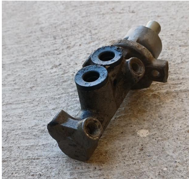
Figura 2-11: Bomba de frenos de 4 salidas, perteneciente al vehículo Citroën AX GTi en estudio.
