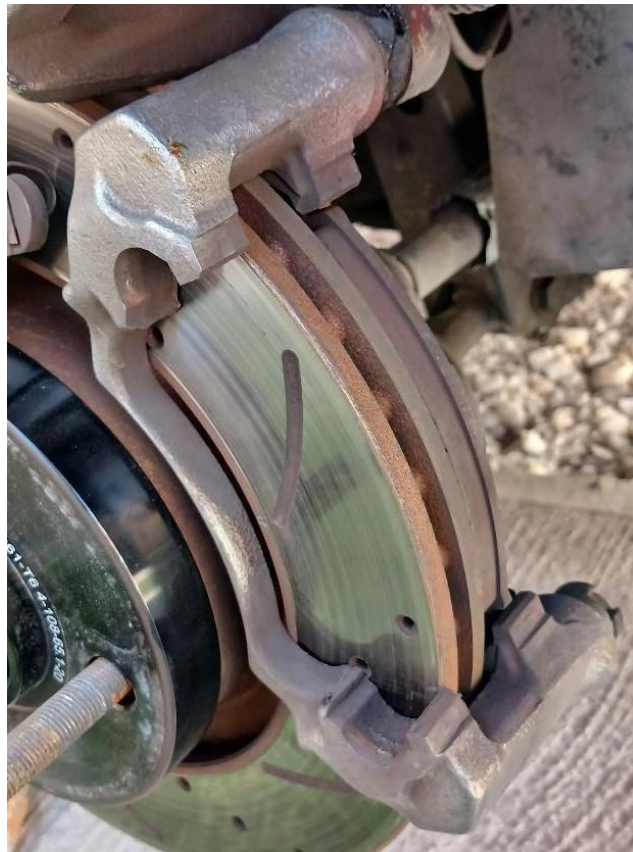
Figura 2-15: Porta caliper de frenos delantero del vehículo Citroën AX GTi en estudio, vista frontal.
