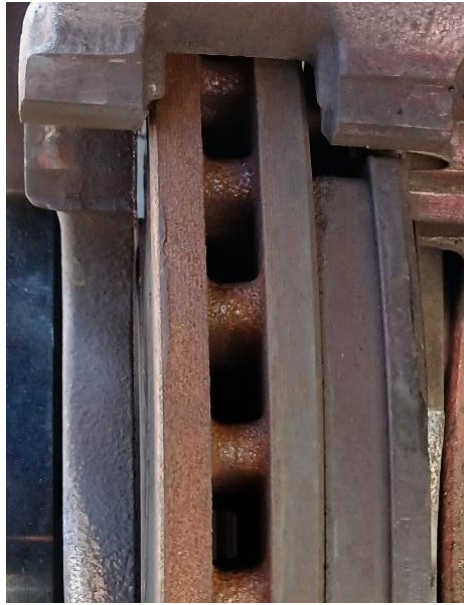
Figura 2-20: Sección interior del disco de frenos ventilado delantero de 266 [mm], instalado en el vehículo Citroën AX GTi en estudio.
