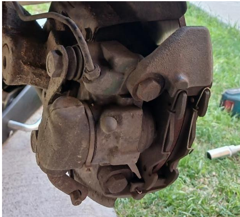
Figura 2-16: Conjunto de frenos trasero del vehiculo citroen AX GTi en estudio, vista posterior.
