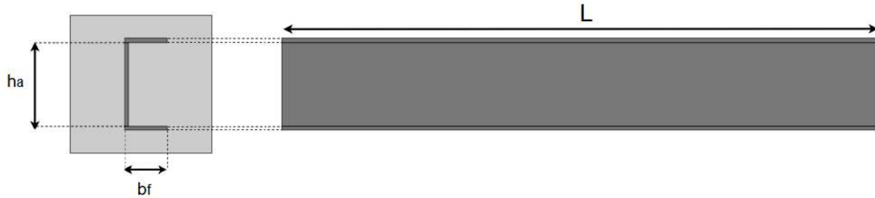
Figura 24: Diseño de la viga de perfil canal.
