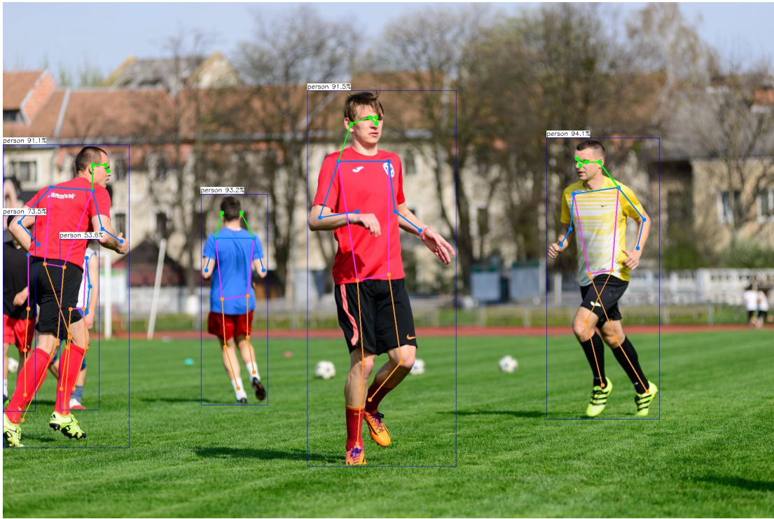
Figura 2.3: Los 17 keypoints del estándar COCO estimados por YOLO11-pose. El keypoint 10 (muñeca derecha) es el punto de referencia empleado en este trabajo.
