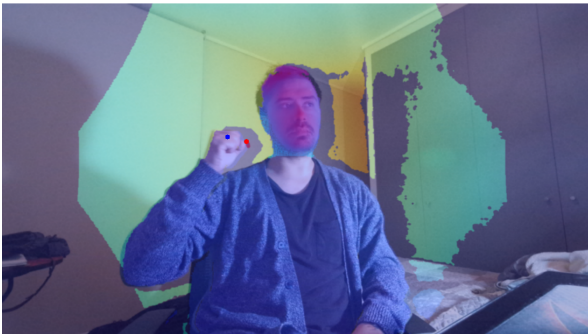
Figura 4.10: Otro ejemplo donde la mano, al ser capturada a alta velocidad, es reconocida erróneamente como parte del rostro.
