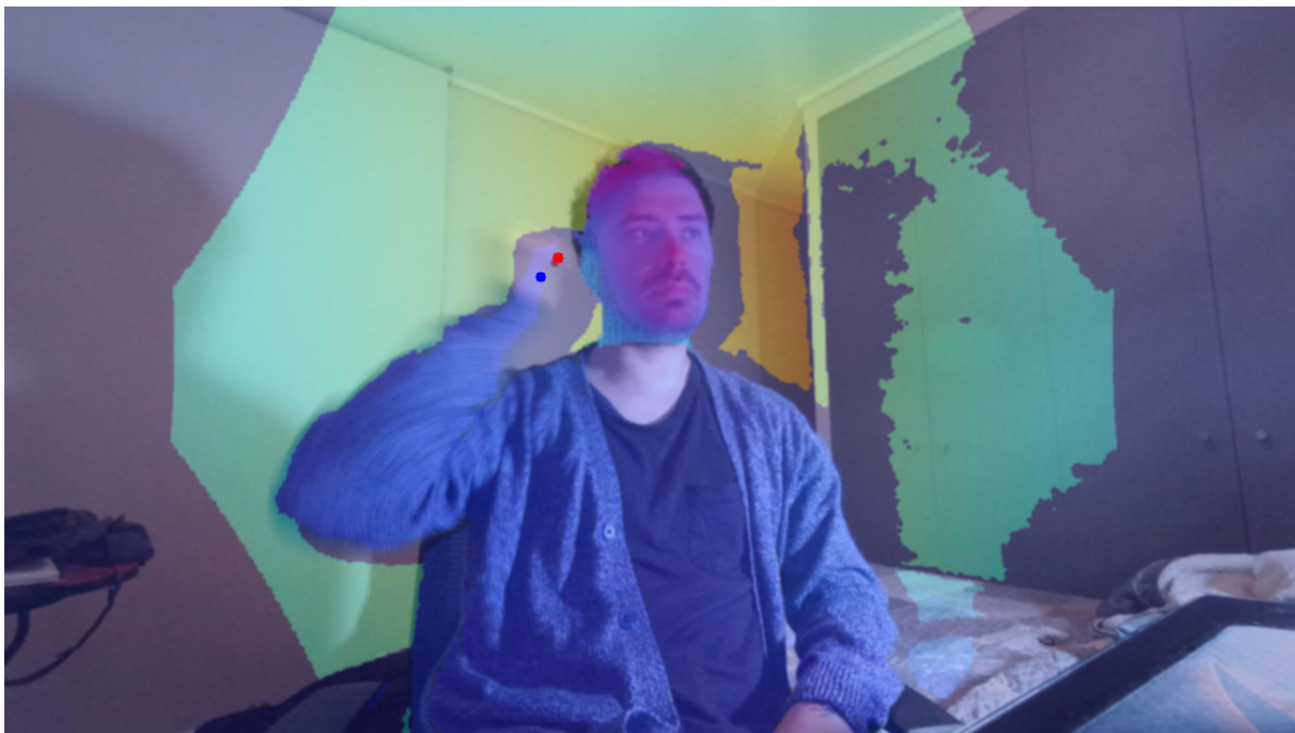
Figura 4.8: En esta captura se entregó una distancia de 42 mm entre el punto rojo y el azul, valor razonable. Se evidencia un problema: parte de la mano, al estar muy cerca del rostro, se toma como parte de la región segmentada, desplazando el punto rojo más allá de lo deseado.
