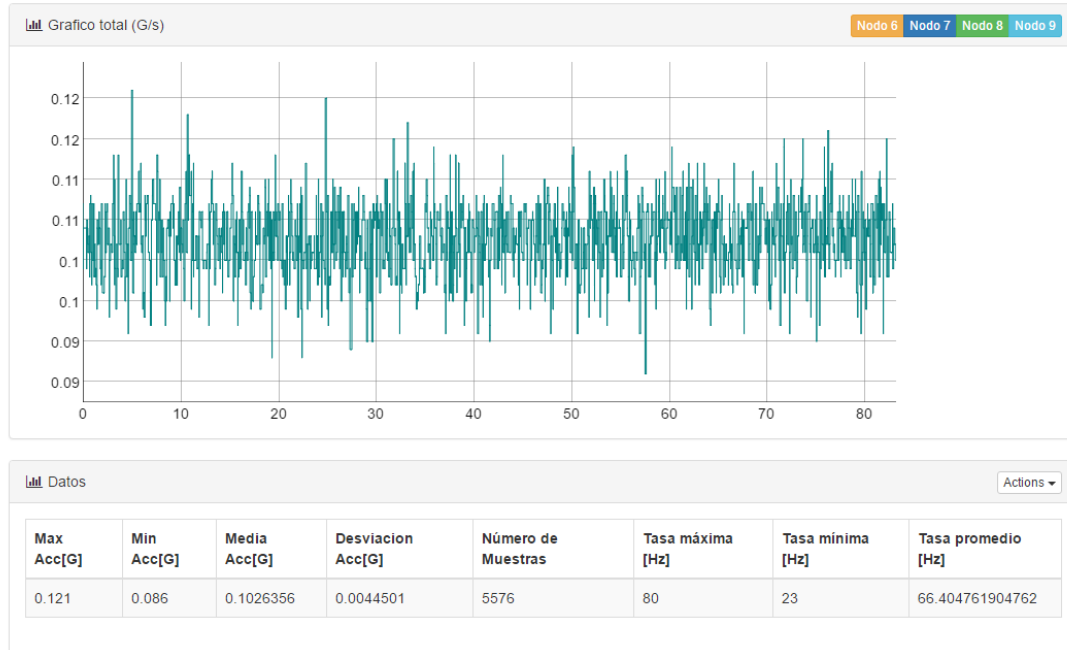
Figura 7.4: Tasa de transmisión en Línea de Vista con transmisor estático. Aceleración [G] y Tiempo [s] (Elaboración propia)
