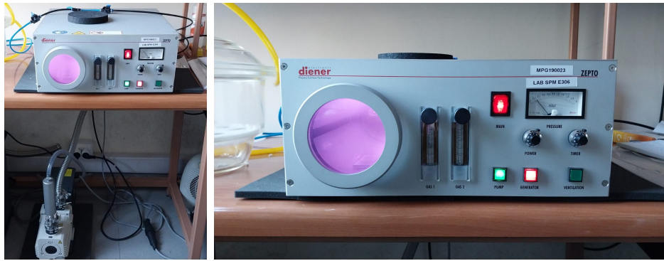
Figura 2.4: Vista completa de Zepto Plasma Cleaner en funcionamiento.
