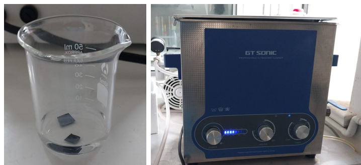
Figura 2.3: (izquierda) Muestras sumergidas en 5 ml de isopropanol antes de ser colocadas en el tanque y (derecha) GT Sonic funcionando a 60% de potencia con el calefactor en OFF.)
