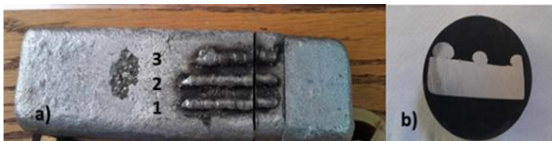
Figura 24. Corte de lingote. (a) corte del sustrato para su posterior análisis. (b) muestra para su análisis.
