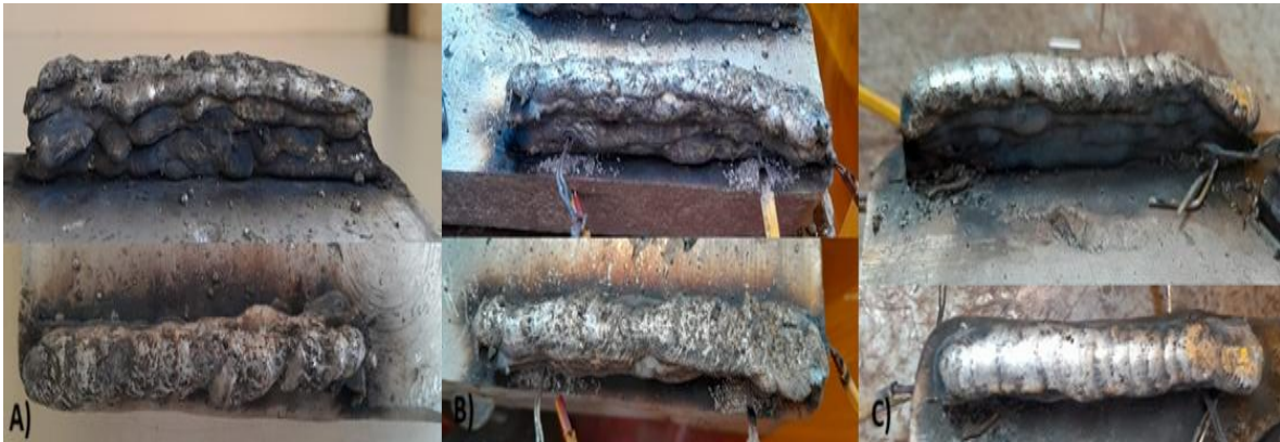
Figura 29. Morfología macroscópica fabricadas por WAAM.(a) muestra de 14V con HI Bajo, (b) muestra de 15V con HI medio y (c) muestra de 16 V con HI Alto.
