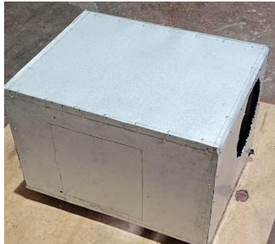
Figura 47. Planchas fijadas a la estructura mientras se van realizando los agujeros correspondientes.
