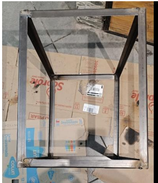
Figura 43. Estructura base soldada utilizando perfiles metálicos.
