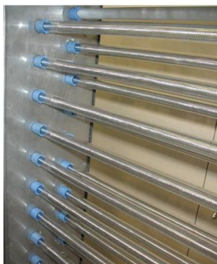
Figura 14. Resistencias de cuarzo utilizadas en aplicaciones industriales
