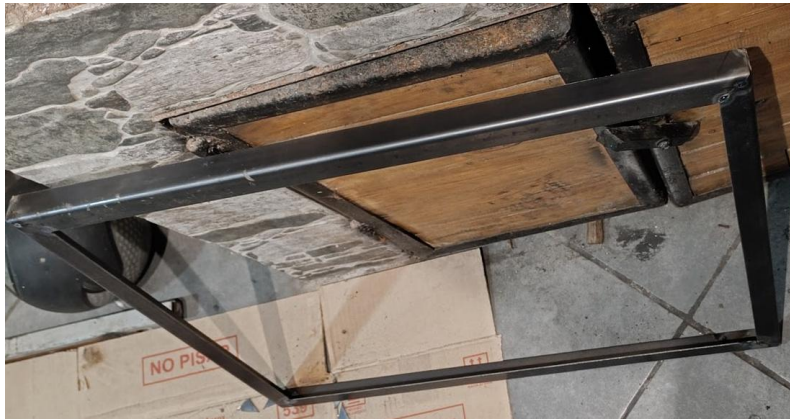
Figura 42. Cuadro soldado utilizando perfiles metálicos.
