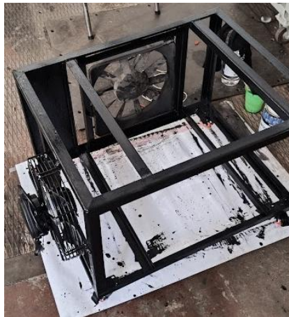
Figura 45. Estructura del banco ya pintada con ventilador, extractor y ruedas instalados.
