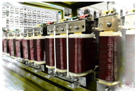
Figura 8. Bobinas inductivas utilizadas en bancos de carga para pruebas de generadores.
