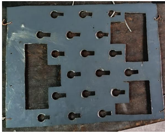
Figura 48. Preparación de las placas de soporte para las resistencias.
