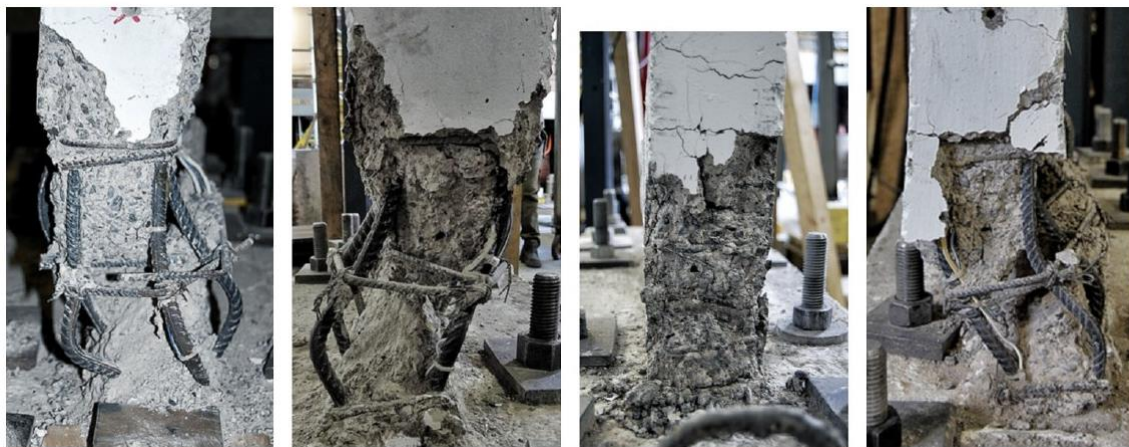
Figura 3.7: Muros W1, W7, W8 y W9 de izquierda a derecha (Hube & de la Llera, 2015)
