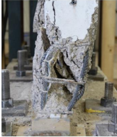
Figura 8.12: Falla del espécimen en un plano diagonal ensayada en laboratorio (Hube & de la Llera, 2015)
