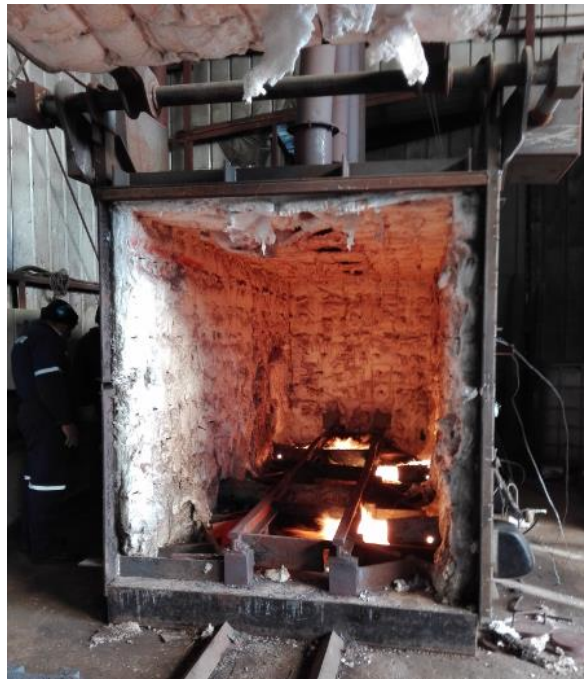
Figura 24. Horno de tratamiento térmico de fabricación propia en ECASO. 4 de sus 3 quemadores en funcionamiento.
