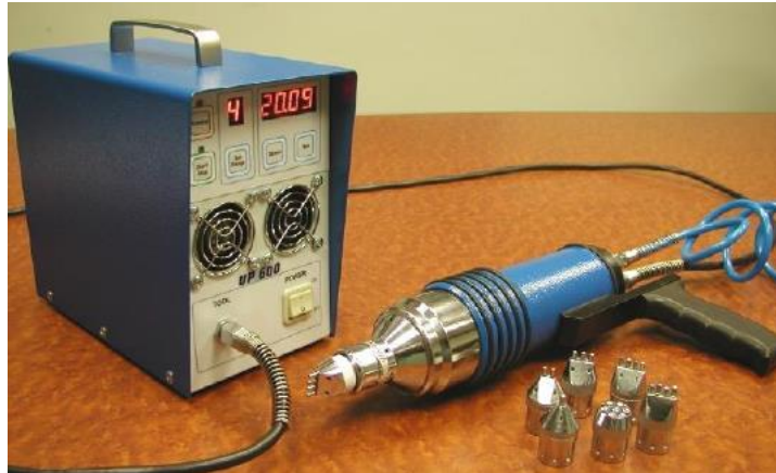
Figura 7. Martillo neumático, con diferentes cabezales y con variador de frecuencia de martilleo.
