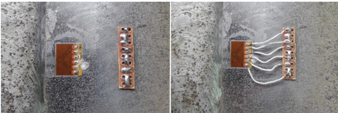
Figura 36. Estampilla y trozo de tarjeta estañadas (izquierda) y cables conectados desde cada punto de la estampilla (6 puntos) a la tarjeta (3 individuales y 3 en pares).
