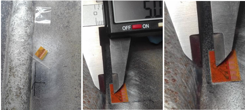
Figura 34. Fotografías de pasos del pegado de estampillas. En la primera imagen se ven las líneas de guía sobre la cinta adhesiva. En las siguientes fotos, se ve la estampilla pegada y la distancia al cordón.
