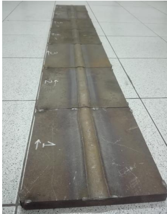
Figura 23. Resultado del proceso SAW, con las placas ya separadas, pero ordenadas en forma creciente.
