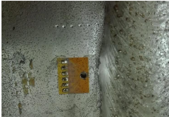
Figura 31. Marcas de la medición de dureza superficial desde el límite del cordón en el cupón 3.
