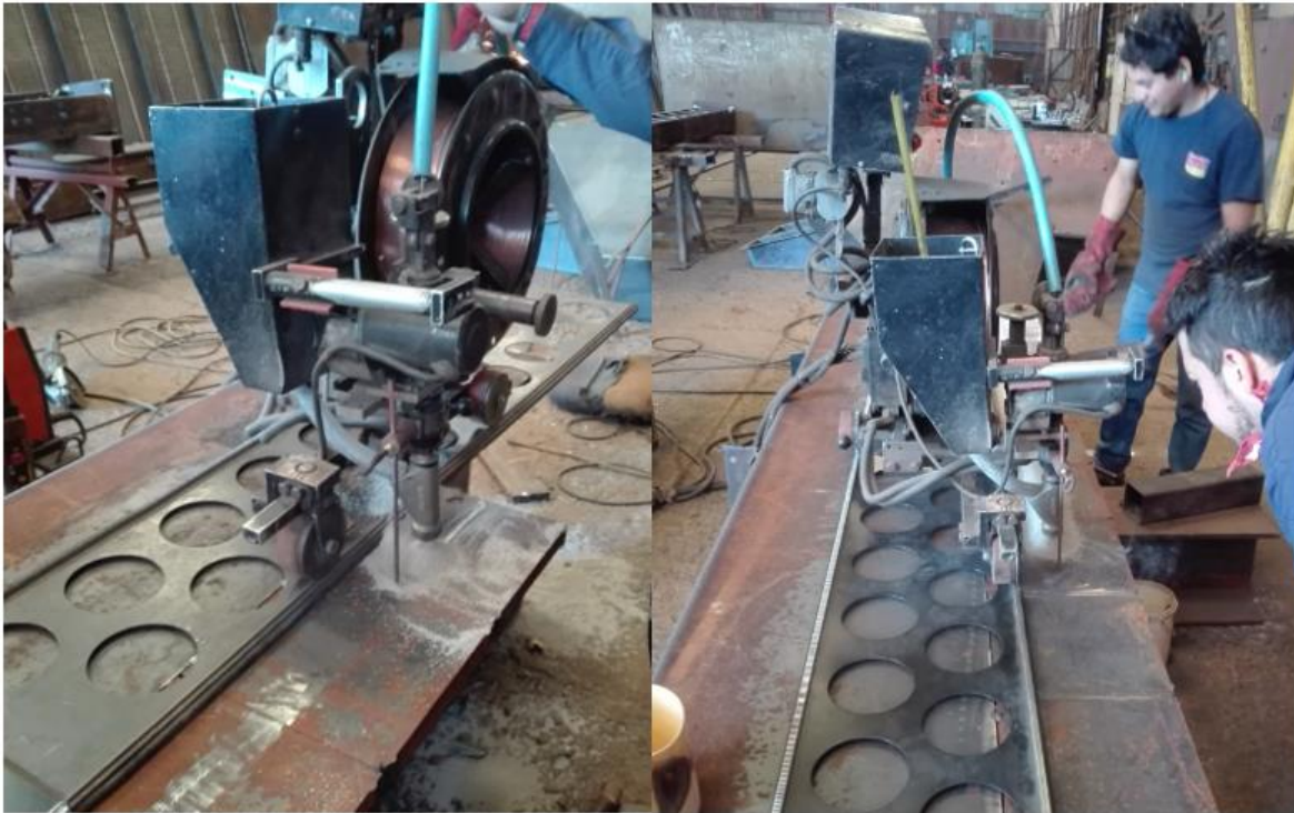
Figura 22. Fotografías del carro SAW en funcionamiento, depositando cordón de soldadura sobre placas en estudio.
