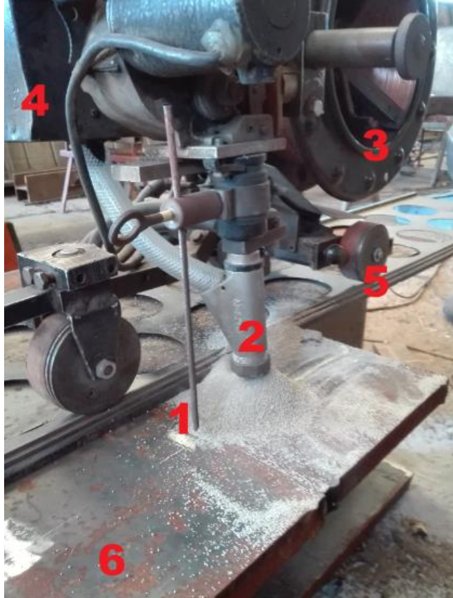
Figura 21. Partes del carro móvil que contiene la antorcha de SAW. (1) Guía de posición. (2) Torcha y descarga de fundente. (3) Carrete de material de aporte/electrodo. (4) Tolva de fundente. (5) Rueda y riel. (6) Pieza soldada.
