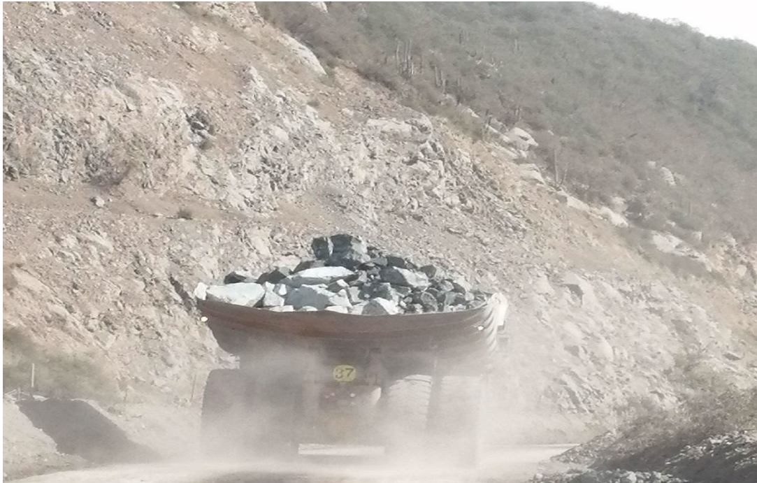
Figura 1- 3 Material extraído desde el yacimiento siendo transportado por un camión caex.
