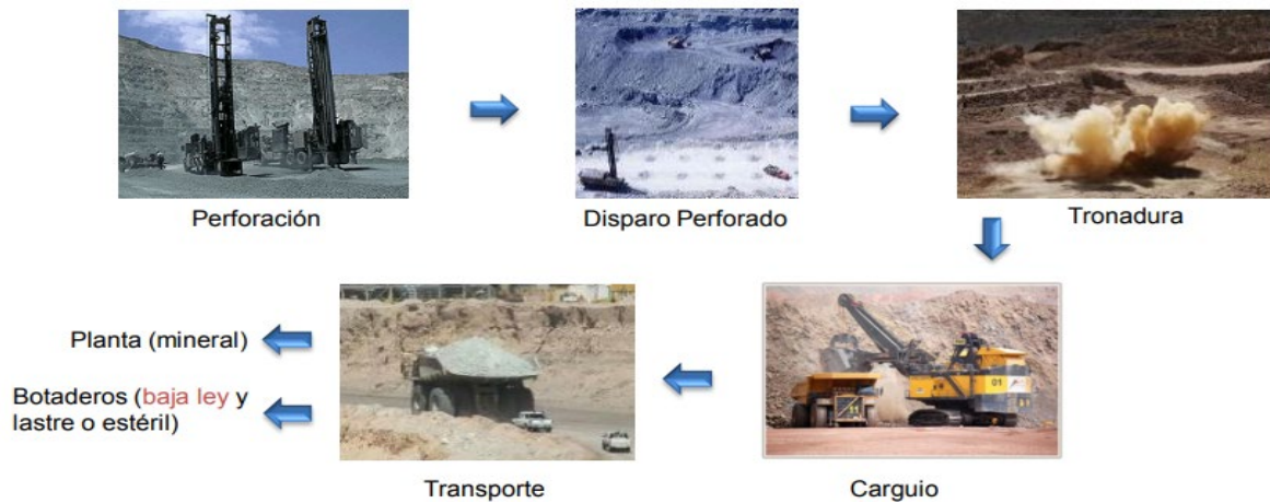
Figura 1- 2 Esquema de subprocesos involucrados en la extracción del mineral.
