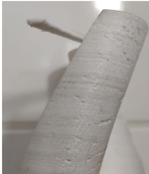
FIGURA 12.10 PROTOTIPO FABRICADO EN ABS EL CUAL FUE PULIDO PARA OBTENER UNA MEJOR CALIDAD SUPERFICIAL.
