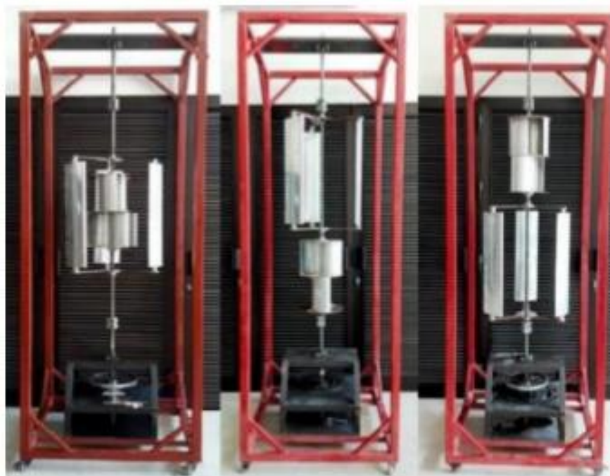
FIGURA 4.18 DISTINTAS COMBINACIONES DE ROTORES PRESENTADOS EN EL EESD 2016. A LA IZQUIERDA LA CONFIGURACIÓN A, EN EL CENTRO LA CONFIGURACIÓN B Y A LA DERECHA LA CONFIGURACIÓN C. “EXPERIMENTAL INVESTIGATIONS OF HYBRID VERTICAL AXIS WIND”.
