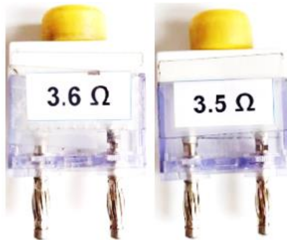
FIGURA 13.5 AMPOLLETAS UTILIZADAS COMO RESISTENCIAS EN EL CIRCUITO ELÉCTRICO.
