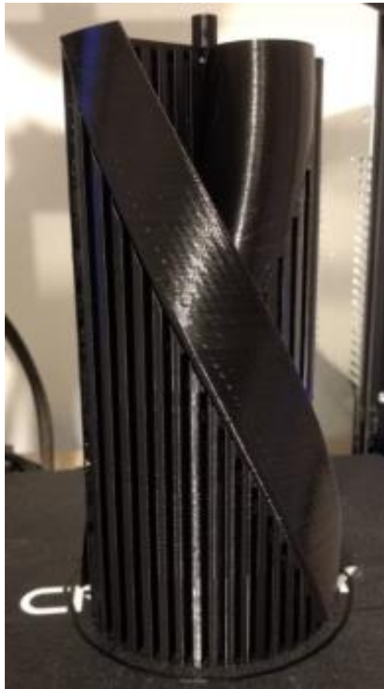
FIGURA 12.7 PROTOTIPO N°5. CON SOPORTES DE EXTRUSIÓN PARA UN MEJOR ACABADO SUPERFICIAL
