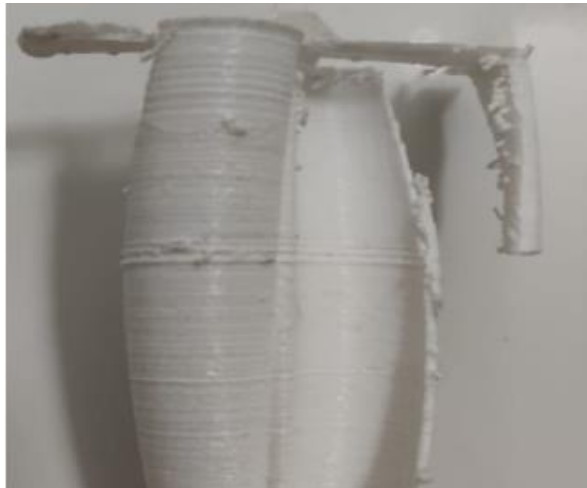
FIGURA 12.9 PROTOTIPO FABRICADO EN ABS CON DEMASIADO MATERIAL DE EXTRUSIÓN POR CAPA.
