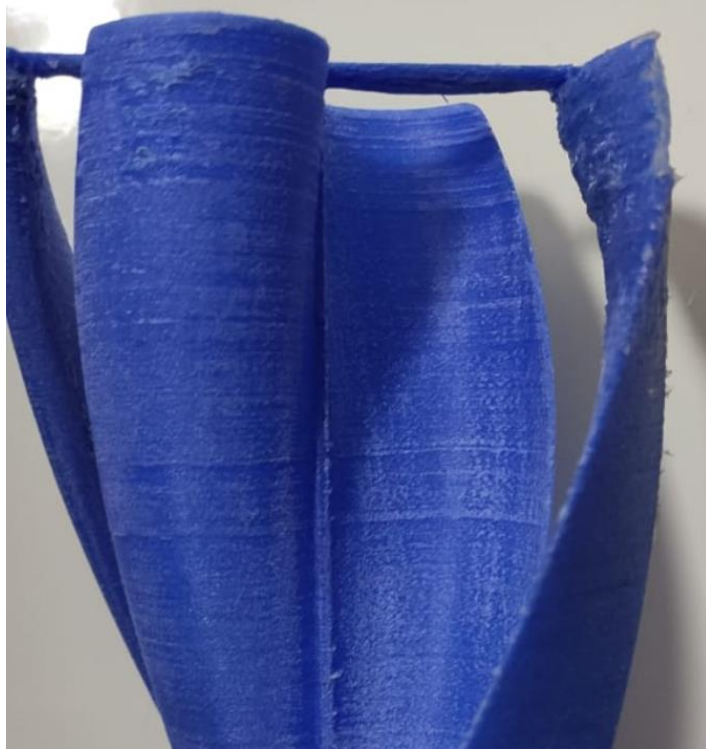
FIGURA 12.11 PROTOTIPO CON FALLA EN ALABE DARRIEUS, CARENCIA DE SOPORTES PARA DAR ESTABILIDAD AL ALABE HELICOIDAL.
