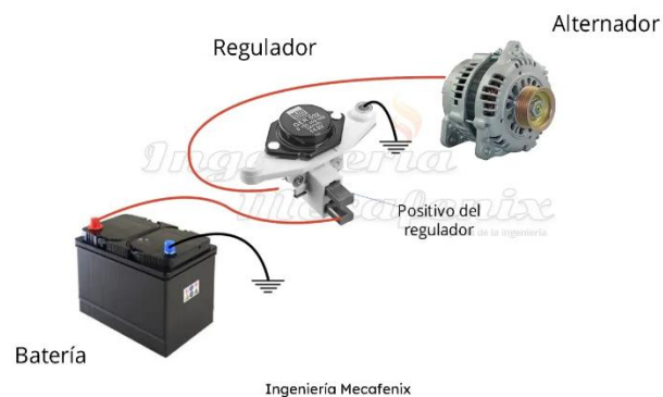
Ilustración 68: Sistema de generación y almacenamiento
