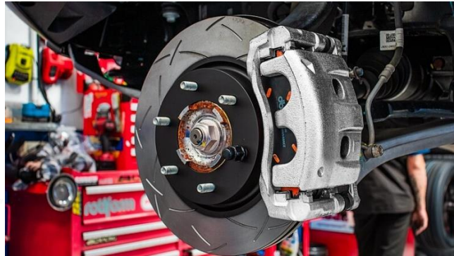
Ilustraciones 60 y 61: Freno de disco
