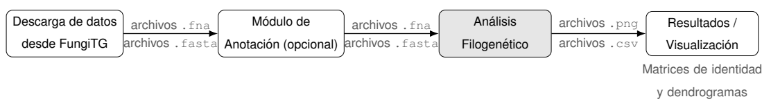
Figura 4.1: Flujo general del módulo de análisis filogenético, mostrando la secuencia de etapas desde la descarga de datos hasta la obtención de resultados visuales.
