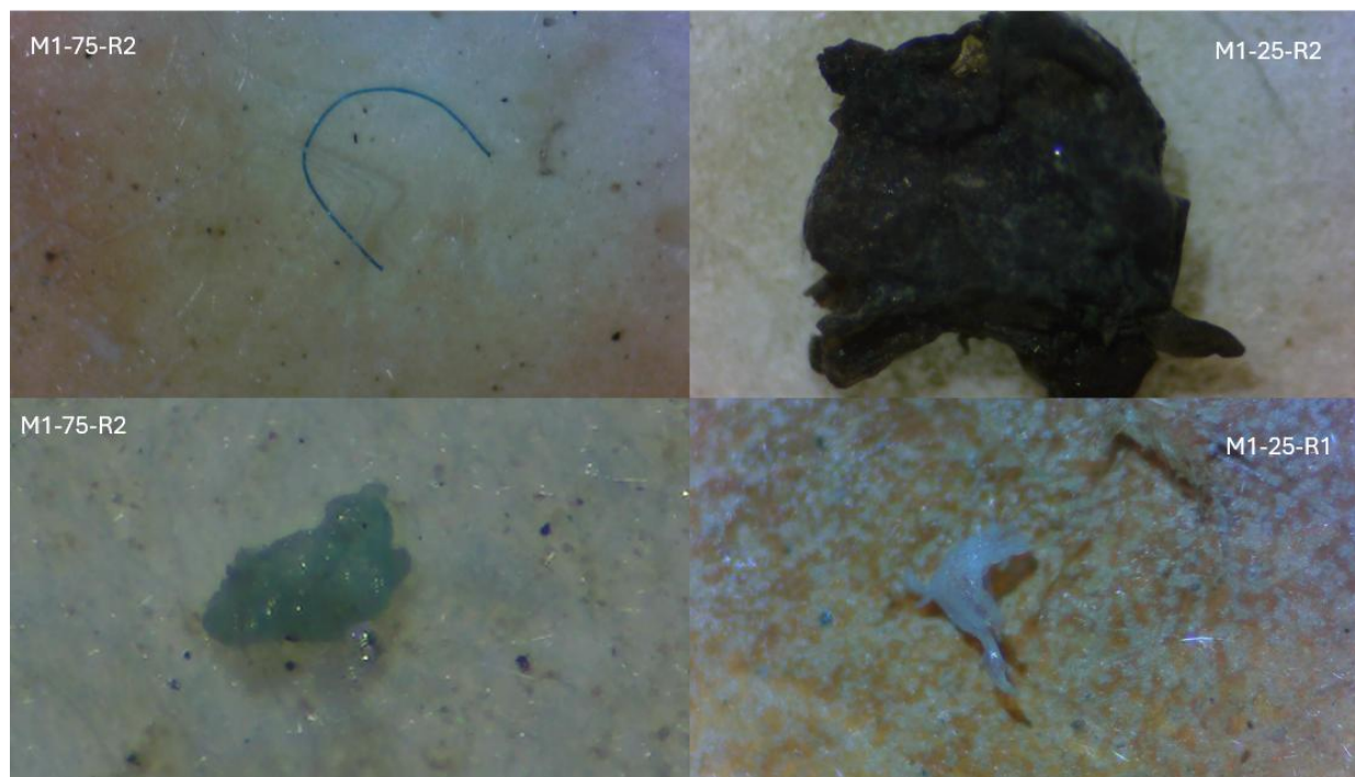
Figura 6.3: MP detectados en el estudio exploratorio de la desembocadura del río Maipo (elaboración propia).
