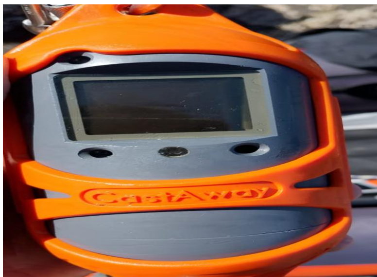
Figura 8.2: CastAway-CTD utilizado para registro de coordenadas, profundidad y perfil de salinidad.
