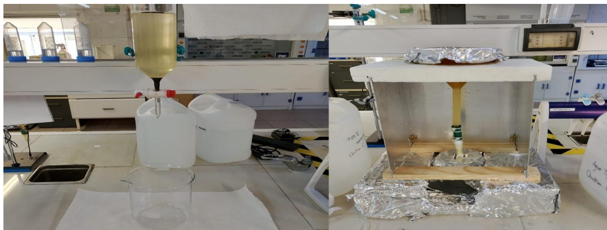
Figura 5.5: Modificación de sistema de decantación empleado en las muestras de Cahuil (registro en laboratorio).
