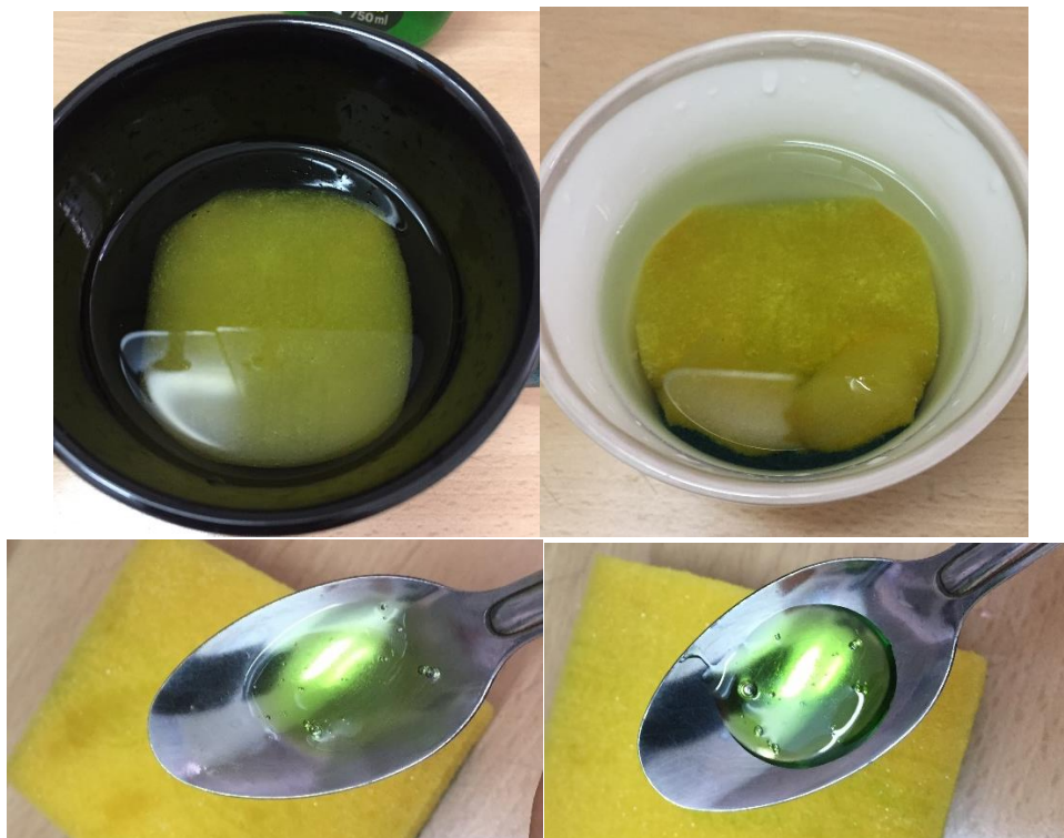
Imagen 37: Condición de remojo por 1 [min] de las esponjas en agua, y dosis de Quix utilizadas para la prueba, con agua sin y con tratamiento, de izquierda a derecha respectivamente.
