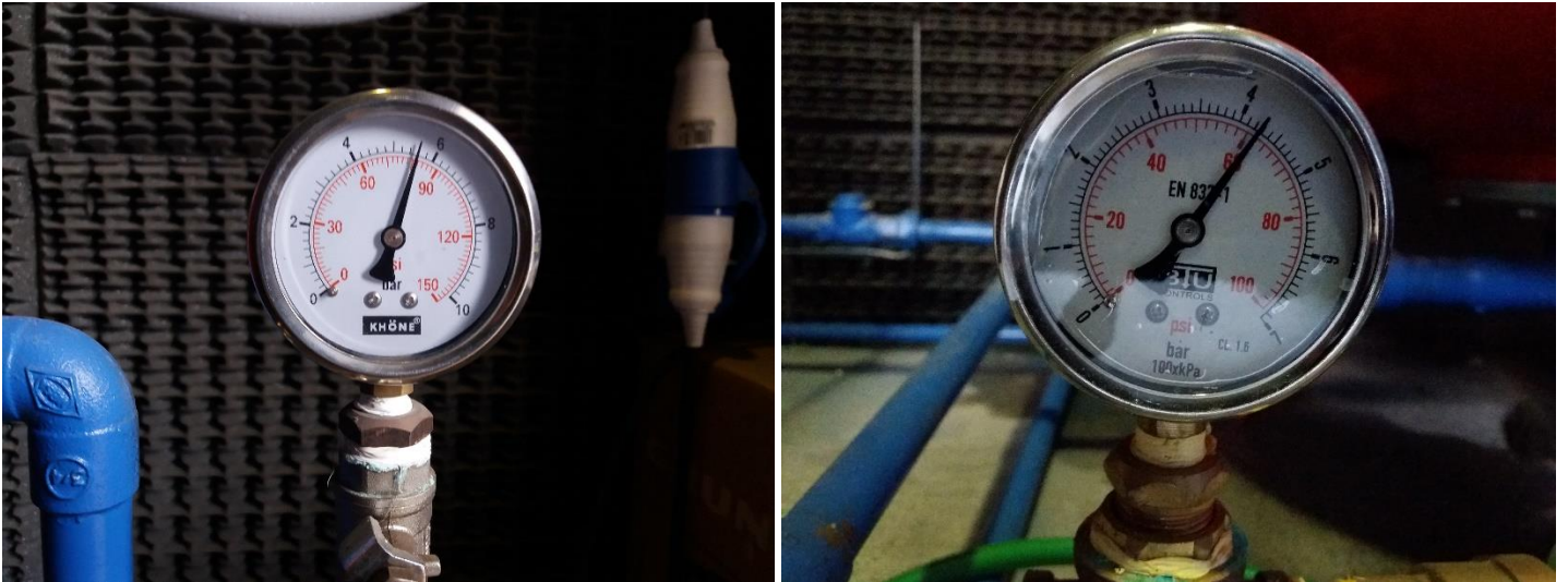
Imagen 4: Presión manométrica pre-acelerador y post-acelerador (de izquierda a derecha), marcando 5,6 [bar] y 4,3 [bar] respectivamente.
