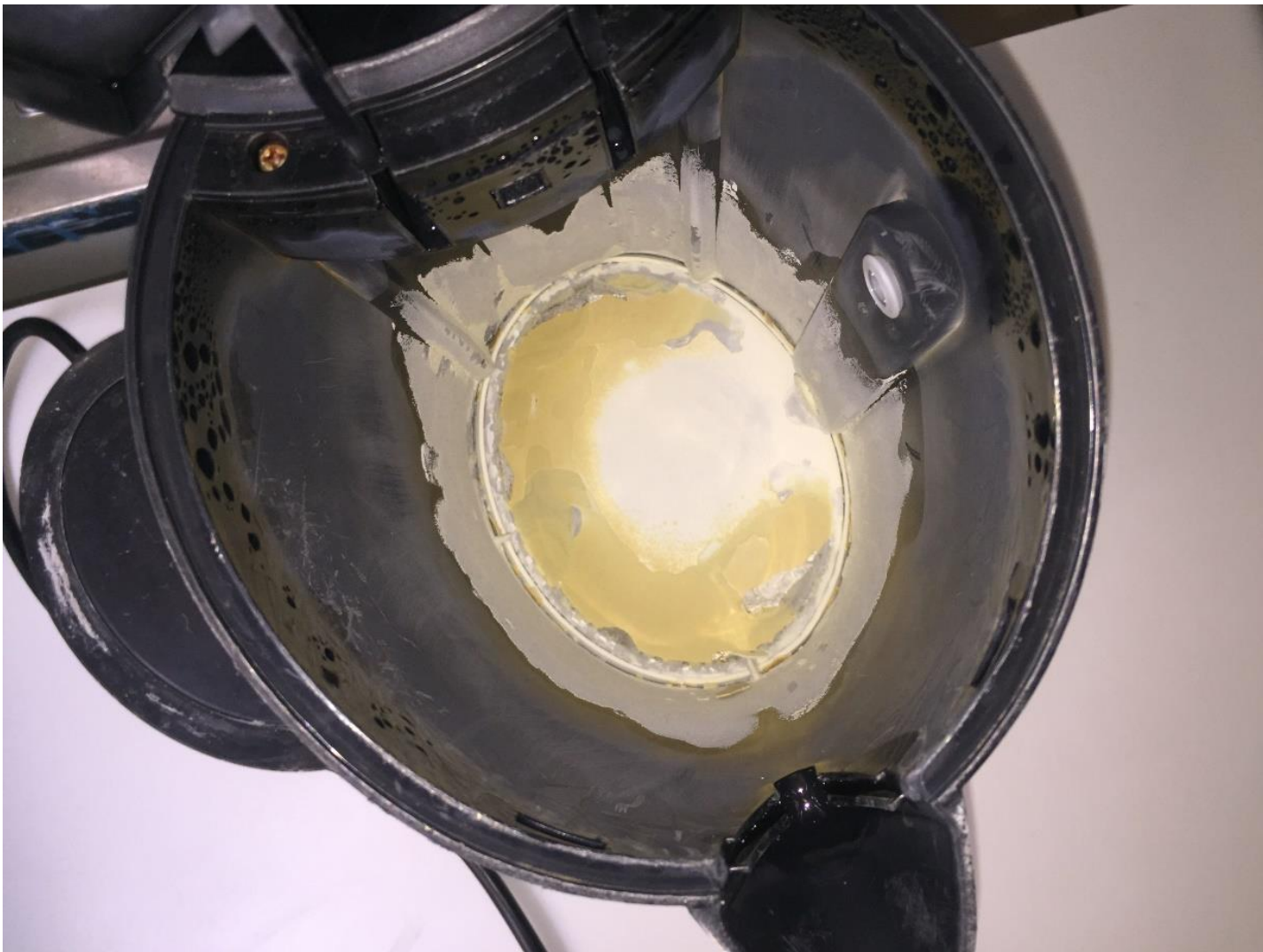
Imagen 10: Hervidor antiguo con serias incrustaciones de sarro. Fotografía del 17 de Agosto, día en que fue dado de baja.
