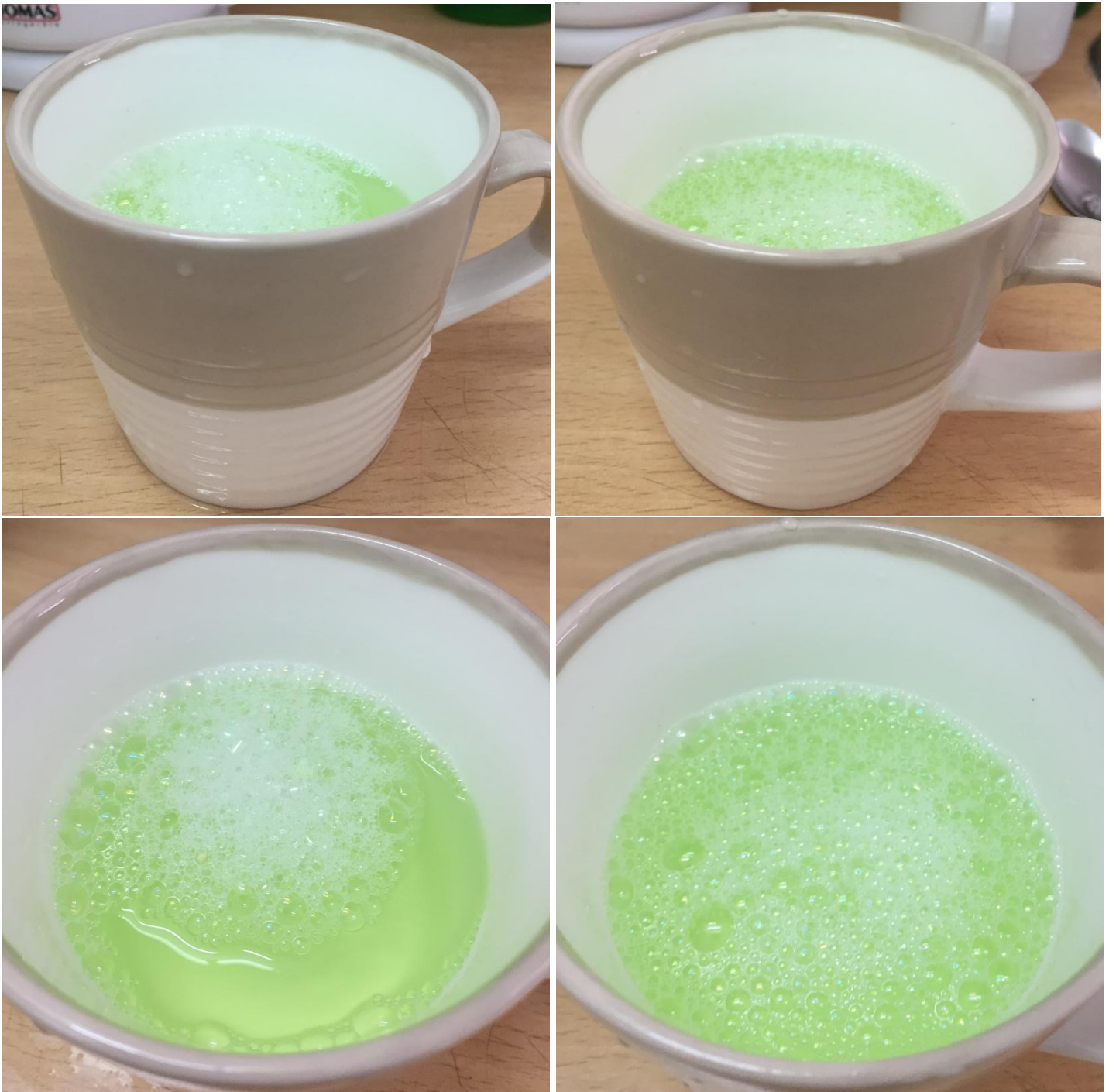
Imagen 35: Condición final de la mezcla de agua con lavalozas luego de revolver por 1 [min]. Agua no tratada del sector de oficinas, y agua tratada del sector de laboratorio, de izquierda a derecha, respectivamente.
