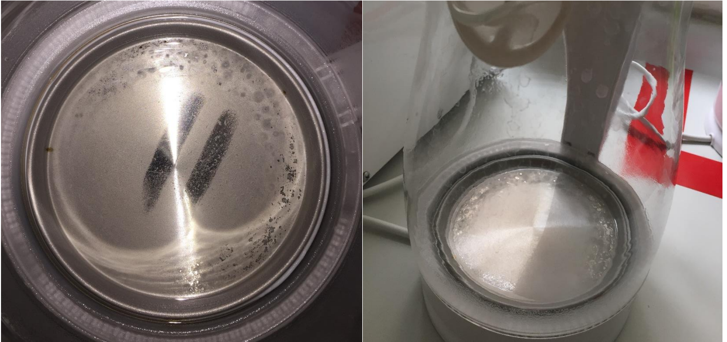
Imagen 30: Hervidor libre del laboratorio, antes de la limpieza. A la izquierda se muestra el fondo del hervidor luego de pasar 2 dedos, sin mayor esfuerzo.
