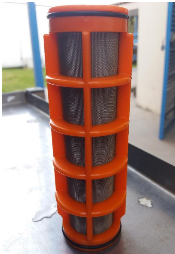
Imagen 7: Vista exterior del filtro, posterior a su limpieza.
