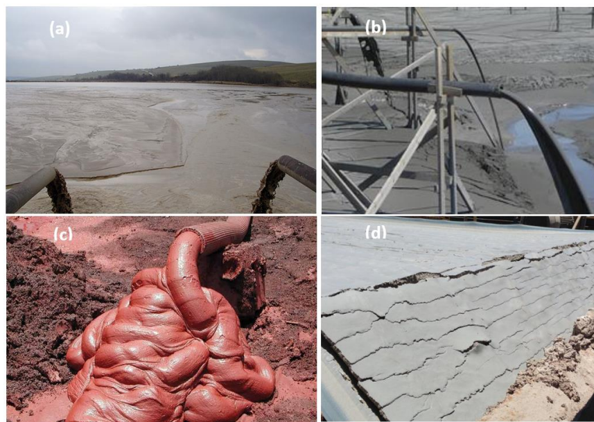
Figura 1: Tipos de relave (a) relave convencional, (b) relave espesado, (c) relave en pasta y (d) relave filtrado.
