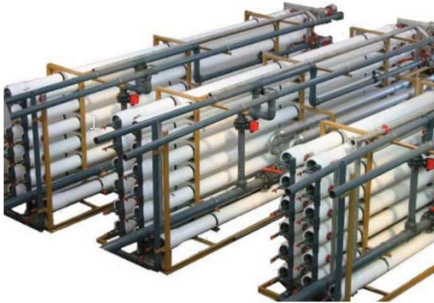
Ilustración 50: Aspecto de los armazones con las cajas de presión.
