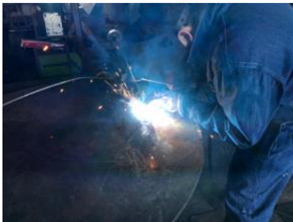
Figura 2-3. Soldadura de acero al carbono
