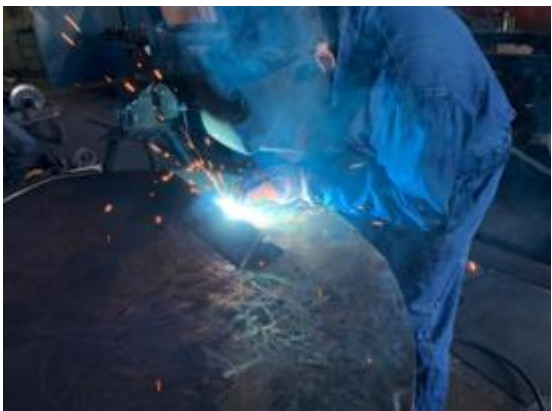
Figura 2-19. Soldadura MIG/MAG C
