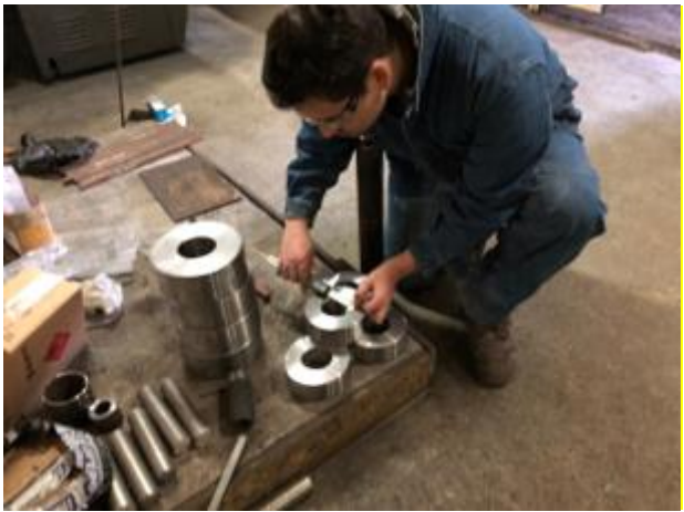
Figura 2-14. Medición de espesores
