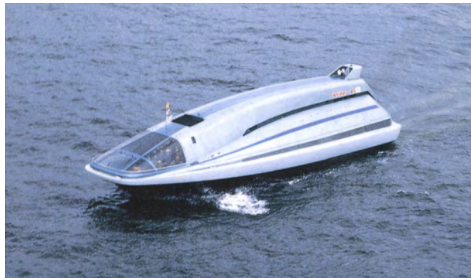
Figura 1.3: Yamato-1, el primer barco propulsado por MHD. Fuente: [2]
