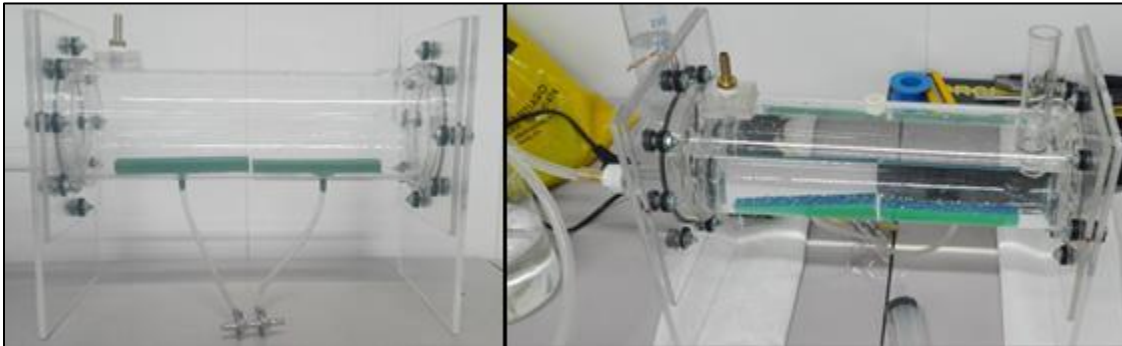
Figura 17.-Izquierda: Estructura de acrílico que se adaptaría como reactor tipo PFR. Derecha: Prueba de estanqueidad de agua.
