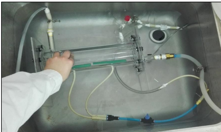
Figura 18.-Prueba de fugo del reactor por sumersión.
