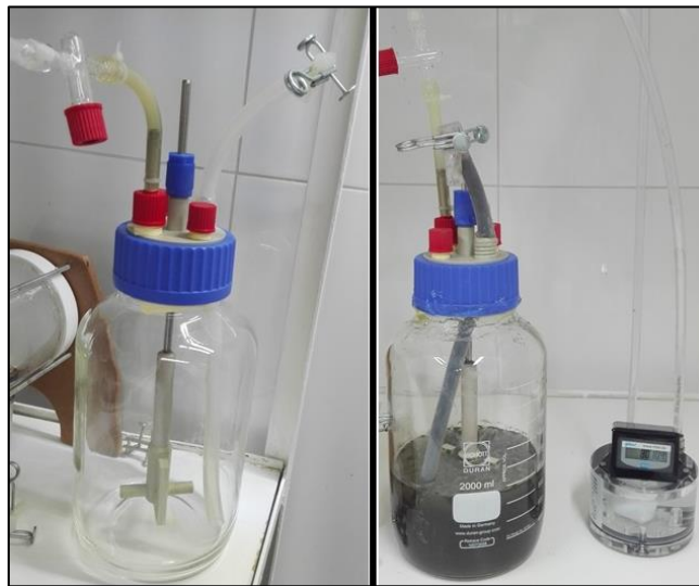
Figura 20.- Izquierda: Adaptación de reactor semi-batch de vidrio en reactor semi-continuo de carga periódica. Derecha: Montaje de reactor semi-continuo .
