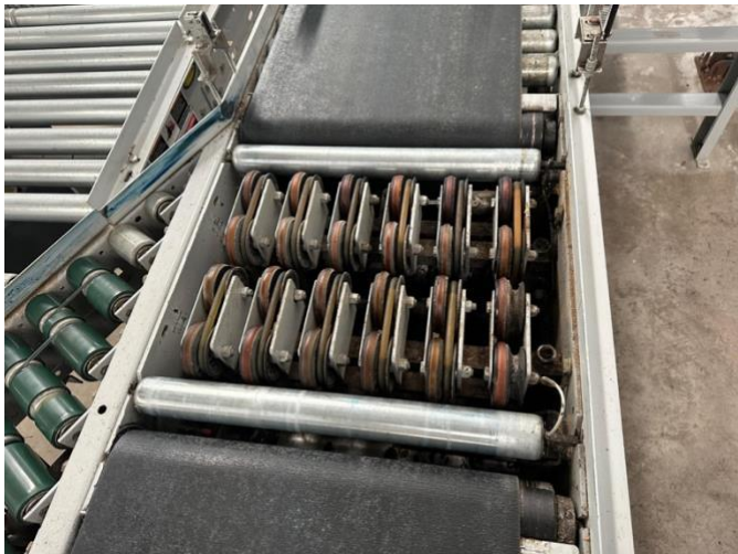
Figura 2-2: Transferencia Neumática (Distribuidor de Cajas Paletizado)
