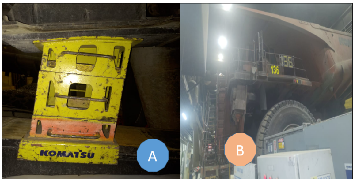
Figura 37: Soporte de tolva instalado (A) y parachoques levantado.
