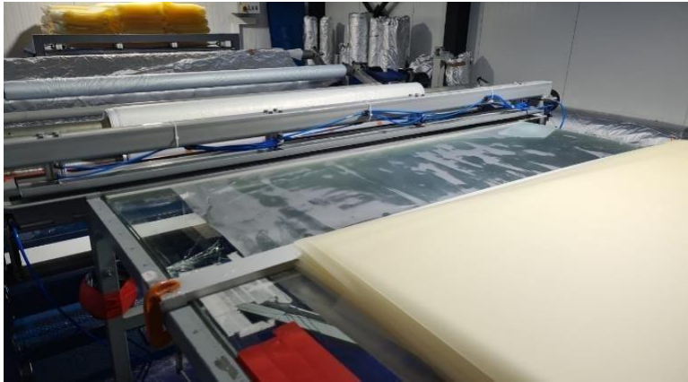
Figura 3-9: Zona de carga PVB.
