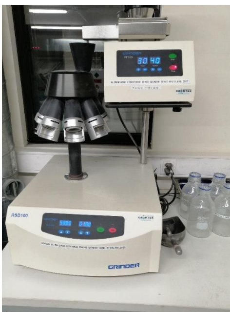
Figura 17: Divisor de muestras rotatorio RSD100 GRINDER serie N° 018.866.0005, alimentado por un "Alimentador vibratorio VF100 GRINDER serie N°017.878.0027"
