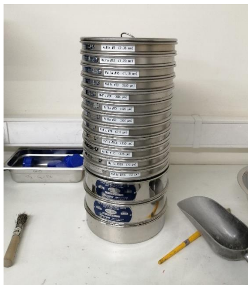
Figura 18: Juego de tamices con mallado #8, #12, #16, #20, #30, #40, #50, #70, #100, #140, #200, #270, #400 y fondo.
