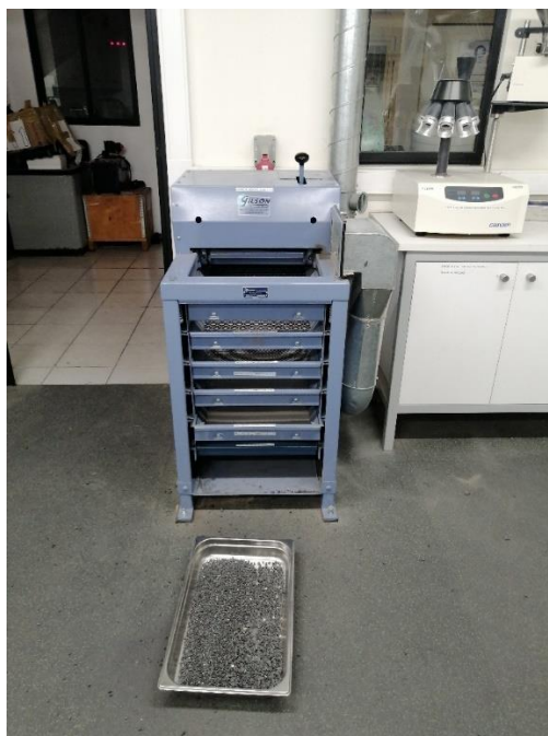
Figura 20: Harnero de laboratorio GILSON TS-1FX
