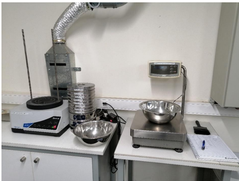
Figura 19: Tamizador RETSCH AS200 CONTROL serie N°1218040412, equipo de tamices, balanza y recipientes de acero para separar muestras
