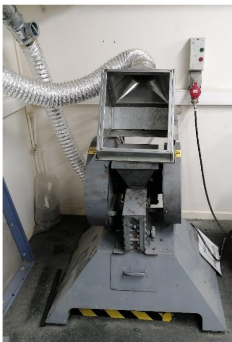
Figura 21: Chancador de mandíbula BICO serie N°72713
