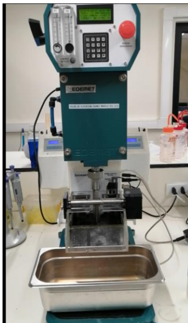
Figura 22: Celda de flotación batch de programación automática EDEMET modelo CFL 3-3
