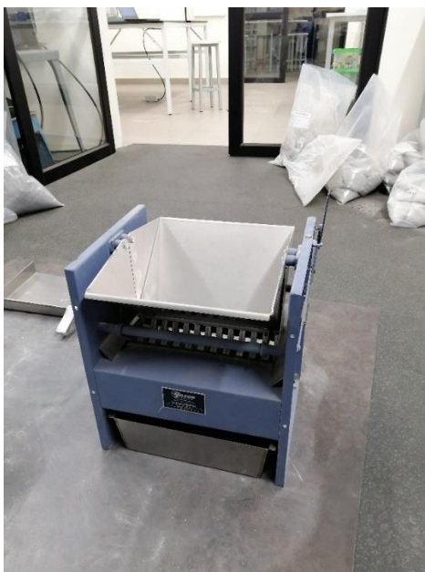
Figura 16: Partidor de rifle GILSON modelo SP-2.5
