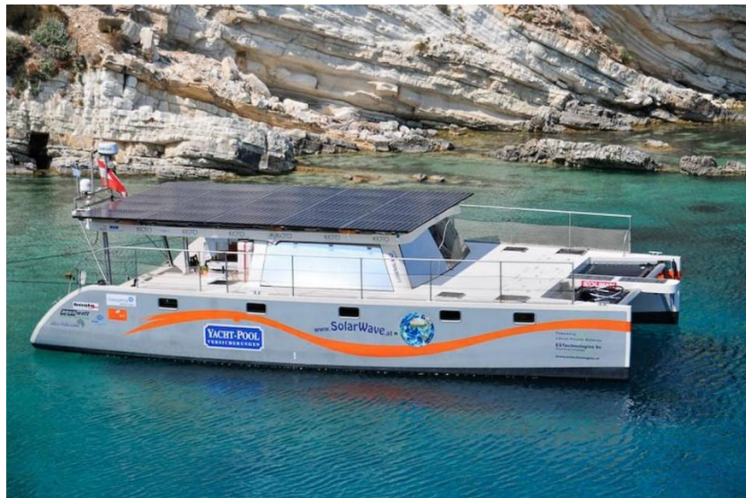
Figura 22: Solarwave 46, construido por Silent Yachts, considerado el primer prototipo de catamarán transoceánico autosuficiente. Extraída de [48].
