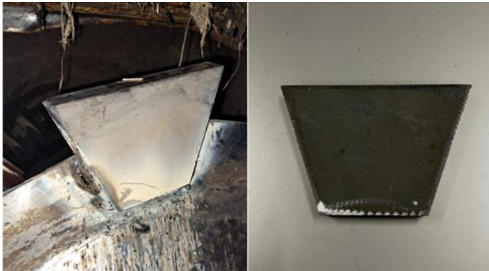
Figura 3-1: Diseño de la propuesta de rompedores de biomasa.
