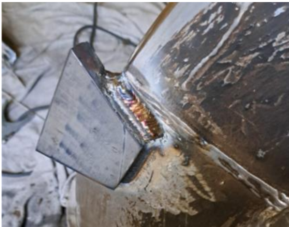
Figura 3-2: Rompedor incorporado al albe del tornillo sin fin.
