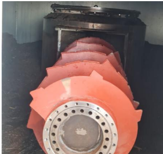
Figura 2-13: Tornillo al interior del silo.
