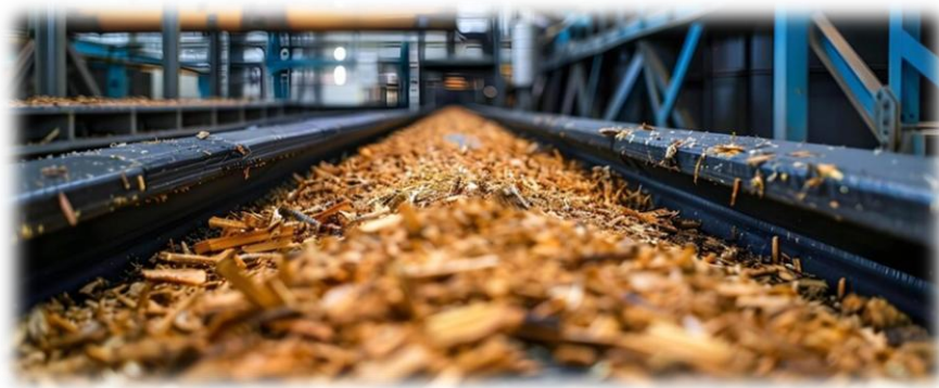
Figura 2-11: Cinta transportadora de biomasa.
