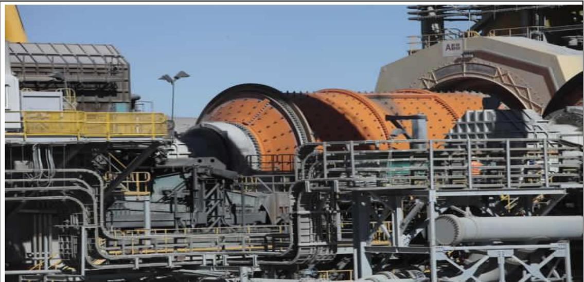
Fig. 1.3.2 Molino Semiautógeno de Compañía Minera Centinela.
