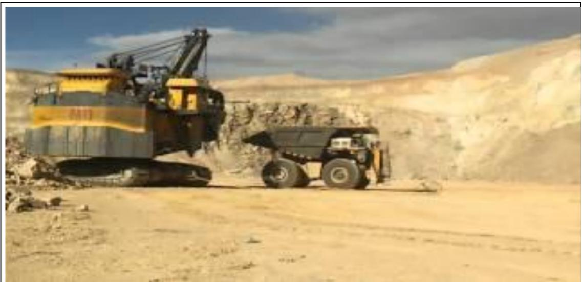
Fig. 1.1.1 Carga de mineral a camión de extracción 797 Caterpillar
