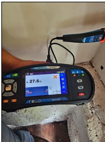
Figura 1-13 Medición de resistencia de puesta a tierra.
