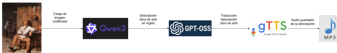
Figura 3.2: Diagrama del módulo generador de descripciones auditivas multimodales. Fuente: elaboración propia.
