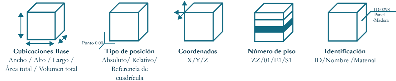
3.2.14. Ejemplos de parámetros nativos en formato IFC Fuente: Adaptado de “Guía de entidades IFC Arquitectura”
